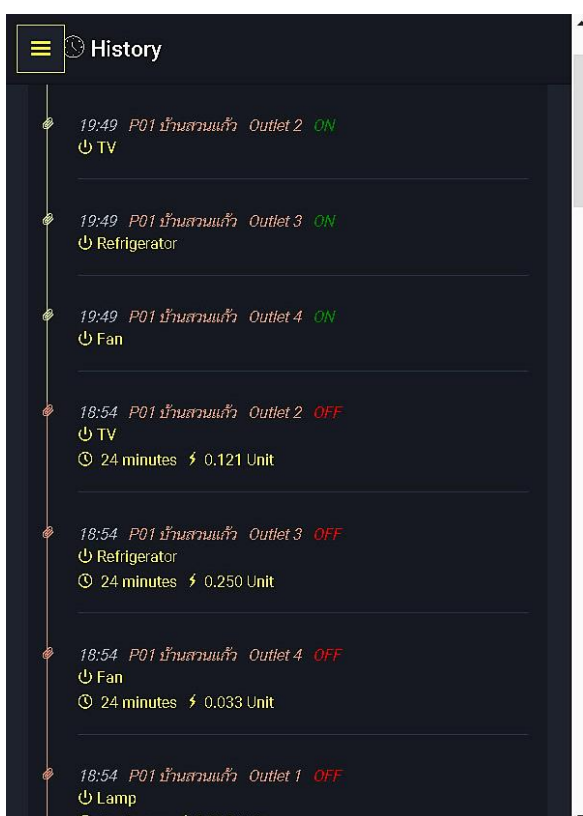
ภาพที่ 8: ประวัติการเปิด/ปิดอุปกรณ์ไฟฟ้า
