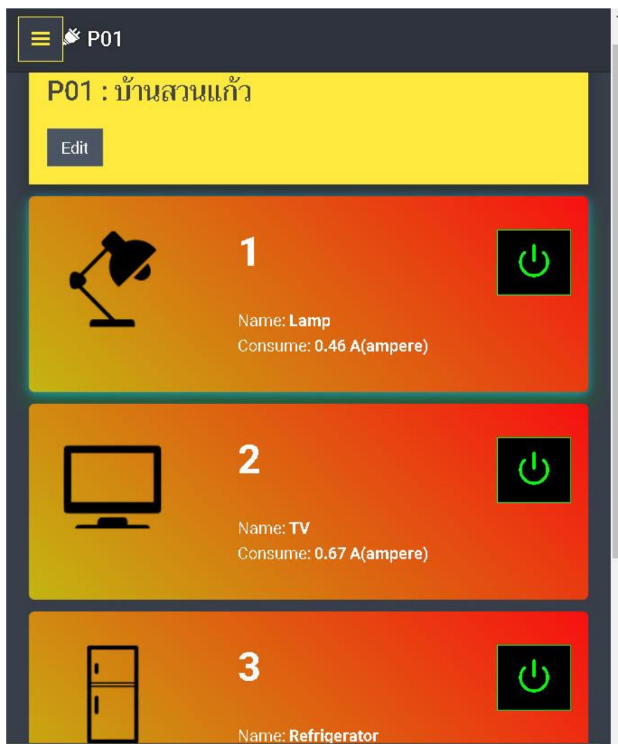
ภาพที่ 2-11: รายการอุปกรณ์ไฟฟ้าที่เสียบใช้งานอยู่
