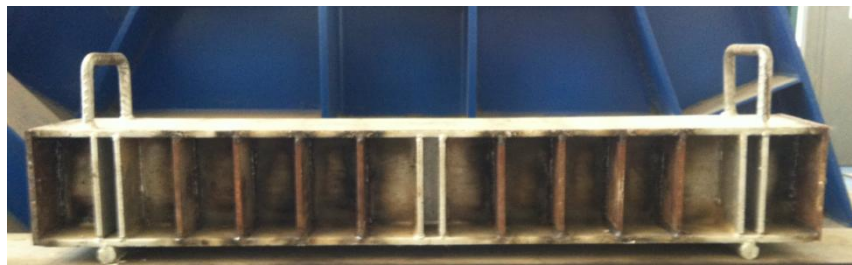
รูปที่ 5.5 คานเหล็กใช้กดแบบ 2 จุด
