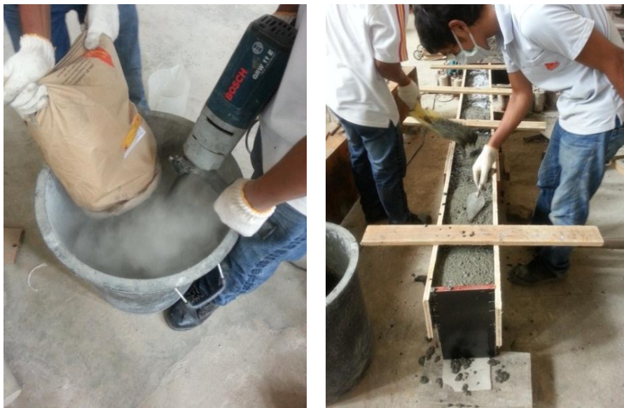
รูปที่ 4.25 การผสม Sika Micro SCC และการเทลงในแบบหล่อ
