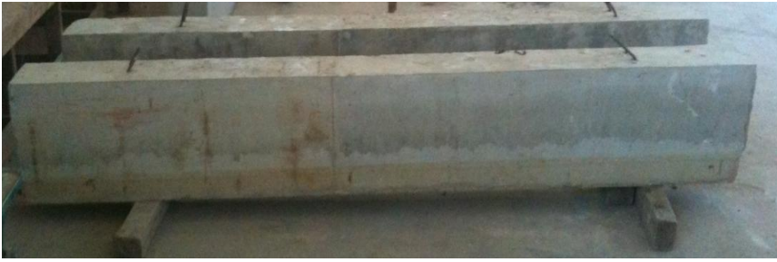
รูปที่ 4.5 คาน B15 ที่ผิวคานมีคราบสนิมเกาะอยู่เล็กน้อย คานอยู่ในสถานะที่ 1
