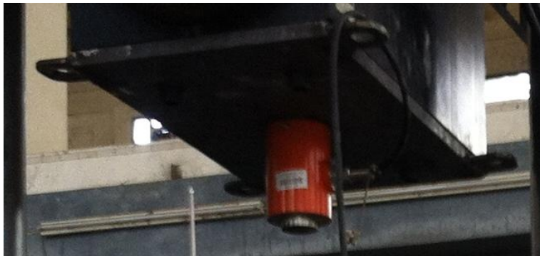
รูปที่ 5.4 แสดงการยึดติดแผ่น Load cell ไปที่ UTM
