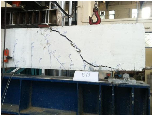
รูปที่ 5.15 ภาพหลังทำการทดสอบคาน B0
