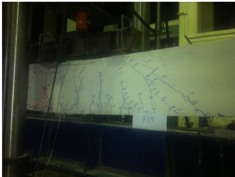
รูปที่ 5.20 ภาพหลังทำการทดสอบคาน B15
