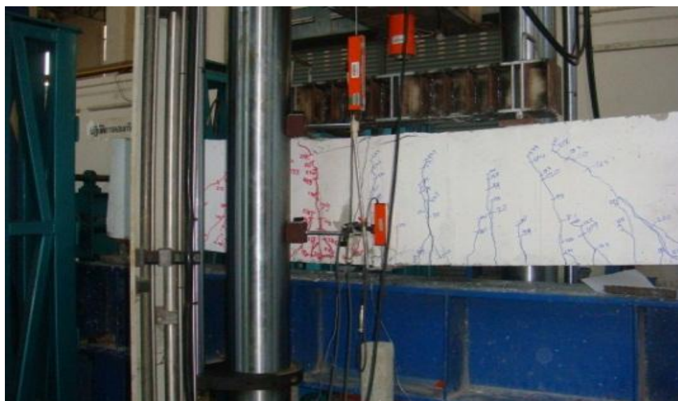
รูปที่ 5.25 ภาพหลังทำการทดสอบคาน B30
