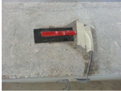
รูปที่ 4.18 การติดตั้ง Electrical Strain Gauge
