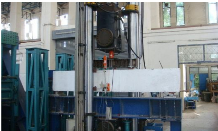
รูปที่ 5.24 ภาพก่อนทำการทดสอบคาน B 30
