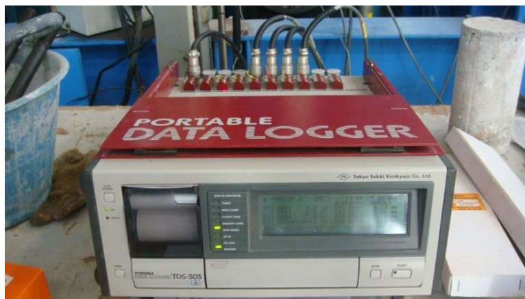
รูปที่ 5.11 เครื่องบันทึกค่าน้ำหนักบรรทุก การโก่งตัวของห้องคาน การเคลื่อนตัวของส่วนหัวของเครื่องทดสอบ
