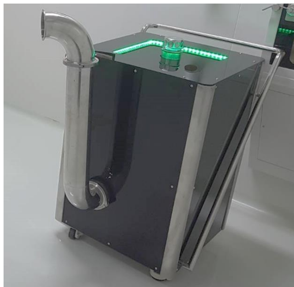
รูปที่ 4.13 การพัฒนาเครื่องฟ่นละอองลอยอนุภาคนิวเคลียสไฮดรอกซิด
