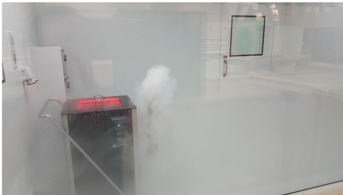
รูปที่ 4.18 ลักษณะละอองลอยเครื่อง Fumigator A โดยส่วนใหญ่จะกระจายอยู่บริเวณพื้นในระหว่างทำการฆ่า
