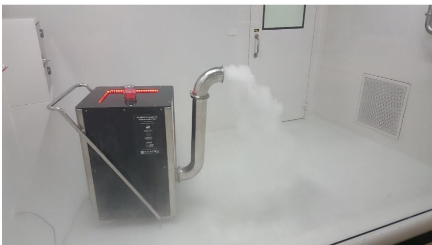
รูปที่ 4.16 ลักษณะละอองลอย เพื่อการฆ่าเชื้อที่สามารถมองเห็น ด้วยเครื่อง Fumigator A
