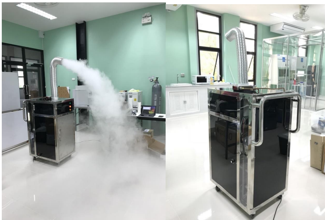
รูปที่ 4.10 เครื่องต้นแบบเครื่องฟ่นละอองลอยฆ่าเชื้อปนเปื้อนในพื้นที่ผลิตด้วยเทคโนโลยีออกซิเดชันขั้นสูง ปลอดสารพิษตกค้าง
