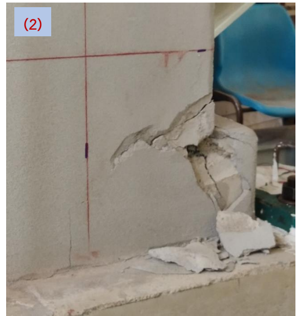
รูปที่ 4.1-12 ความเสียหายของ SP4 ที่ระยะเคลื่อนตัว 1.5%
