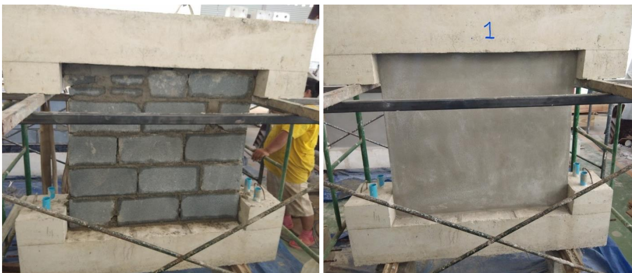
รูปที่ 3.1-4 ขั้นตอนการเตรียมตัวอย่างทดสอบ SP1
