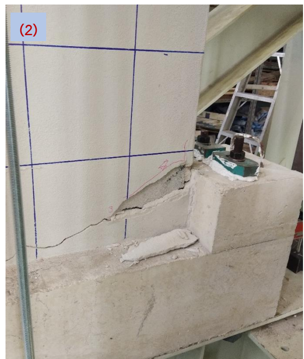
รูปที่ 4.1-3 ความเสียหายของ SP1 ที่ระยะเคลื่อนตัว 1.25%
