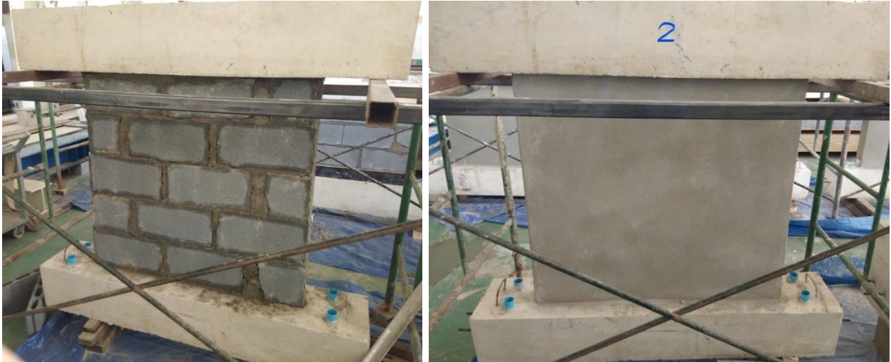
รูปที่ 3.1-5 ขั้นตอนการเตรียมตัวอย่างทดสอบ SP1
