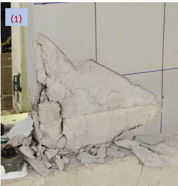
รูปที่ 4.1-9 ความเสียหายของ SP3 ที่ระยะเคลื่อนตัว 3.70%
