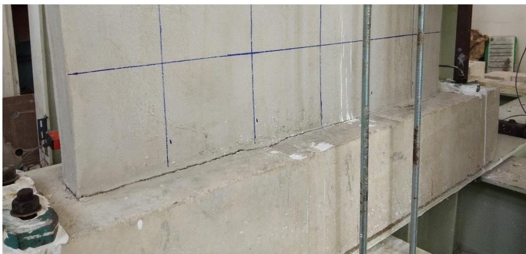
รูปที่ 4.1-5 ความเสียหายของ SP2 ที่ระยะเคลื่อนตัว -0.25%
