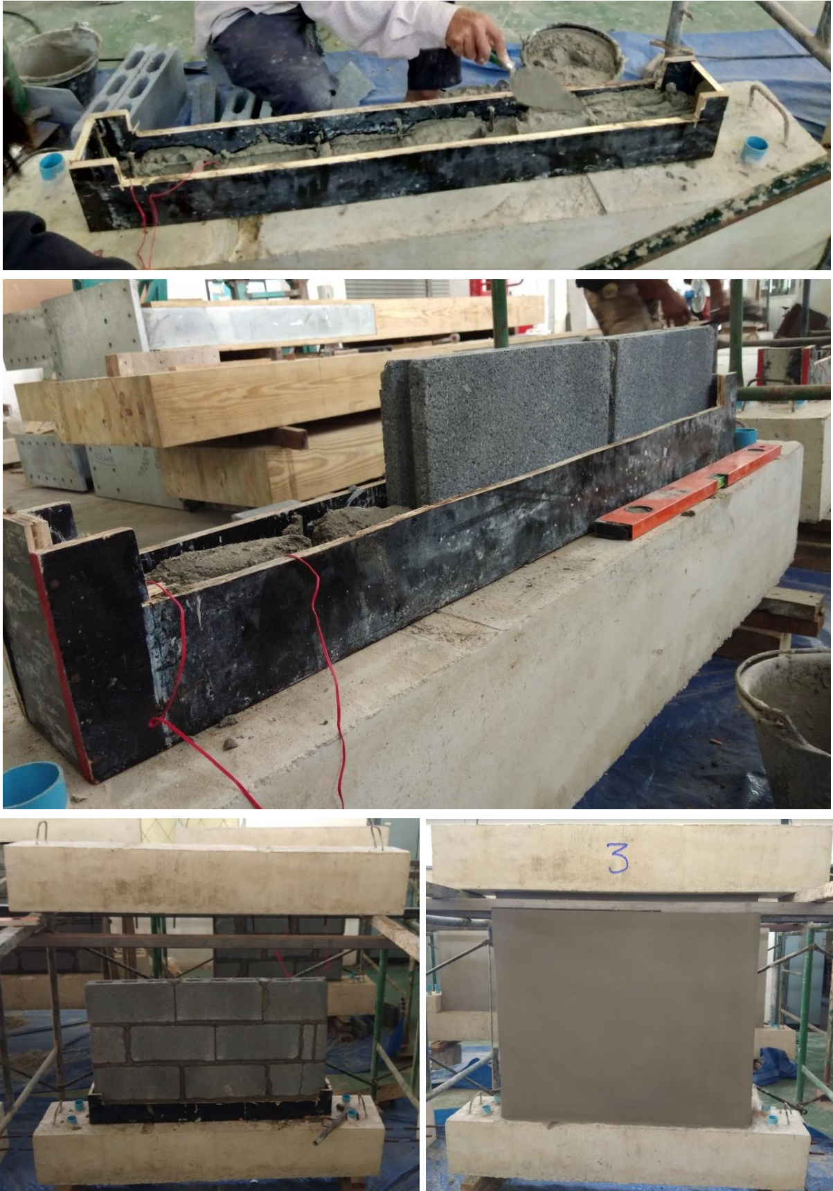
รูปที่ 3.1-7 ขั้นตอนการเตรียมตัวอย่างทดสอบ SP3
