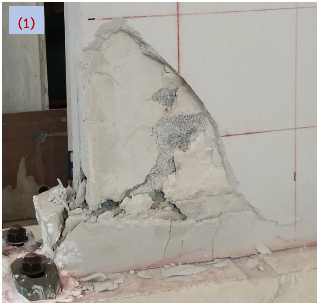
รูปที่ 4.1-12 ความเสียหายของ SP4 ที่ระยะเคลื่อนตัว 1.5%
