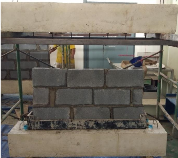
รูปที่ 3.1-9 ขั้นตอนการเตรียมตัวอย่างทดสอบ SP4
