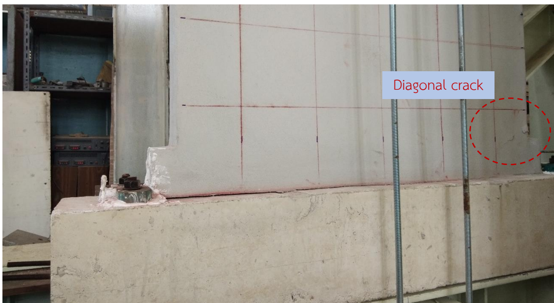
รูปที่ 4.1-11 ความเสียหายของ SP4 ที่ระยะเคลื่อนตัว -0.50%
