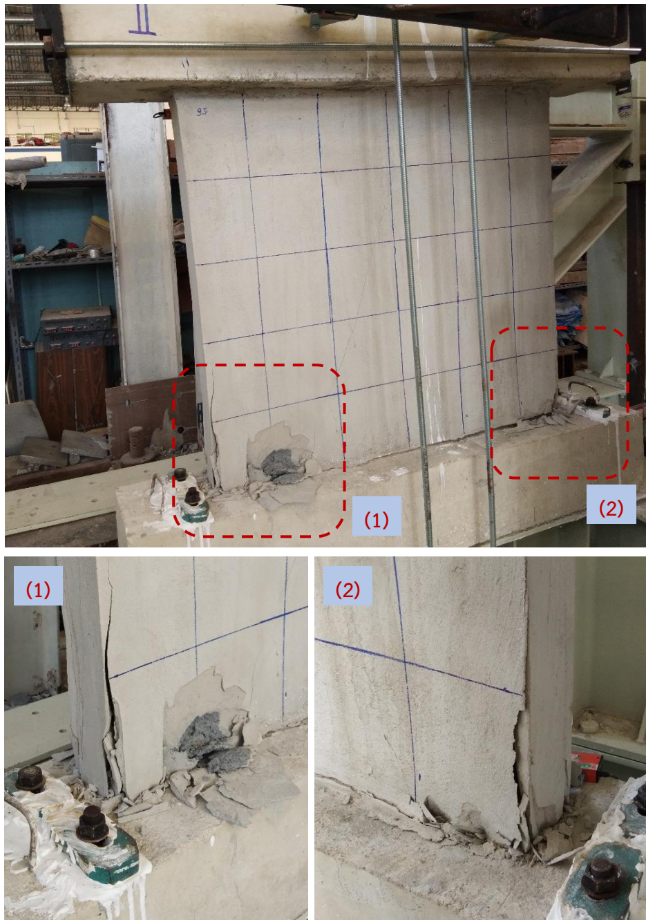
รูปที่ 4.1-6 ความเสียหายของ SP2 ที่ระยะเคลื่อนตัว 4.0%
