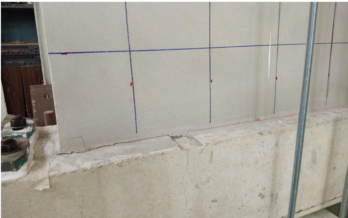
รูปที่ 4.1-8 ความเสียหายของ SP3 ที่ระยะเคลื่อนตัว -0.25%
