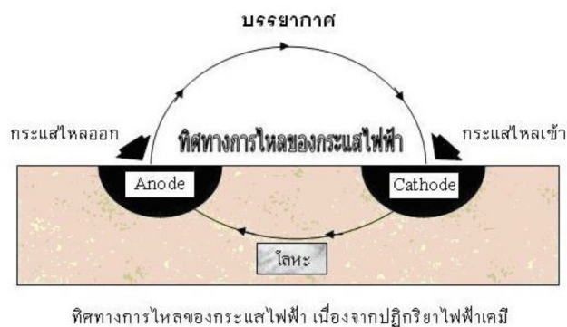
ภาพที่ 2-12 ทิศทางการไหลของกระแสไฟฟ้า (วรวิทย์ จันท์สุวรรณ, 2554)
