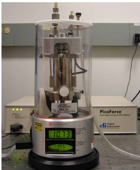
ภาพที่ 2-19 กล้องจุลทรรศน์แรงอะตอม (AFM) แบบ Multimode (เข้าถึงได้จาก : https://sjhsrc.wikispaces.com/AFM?responseToken=d0fe8c810e5c9a263a3ddde790eb69f2 )
