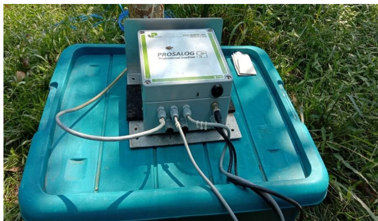
ภาพที่ 5 อุปกรณ์จ่ายไฟและเก็บข้อมูลของ sap flow ซึ่งเป็นวิธีการที่พัฒนามาจากเทคนิคของ Granier method
