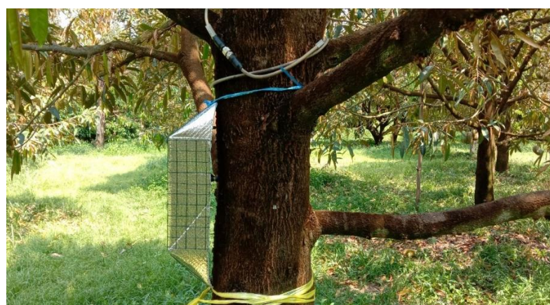
ภาพที่ 6 อุปกรณ์และการติดตั้ง sap flow ในต้นทุเรียนพันธุ์หมอนทอง อายุ 7 ปี ในพื้นที่อำเภอ มะขาม จังหวัดจันทบุรี
