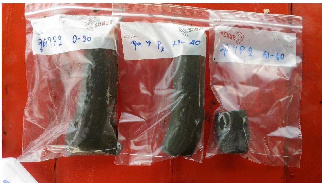
ภาพที่ 3.9 ลักษณะการเก็บดินตัวอย่างจากบริเวณพื้นที่สาขาเพื่อนำไปผึ่งให้แห้งที่ระดับความลึก 0-20, 20-40 และ 40-60 เซนติเมตร บริเวณแหลมกลัด อำเภอลแหลมกลัด จังหวัดตราด
