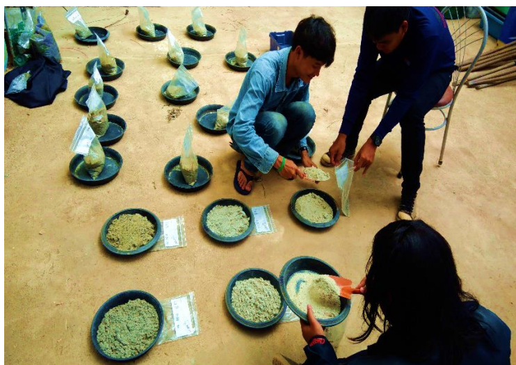
ภาพที่ 3.11 การเก็บดินตัวอย่างที่แห้งแล้วใส่ถุงซิปล็อคเพื่อส่งวิเคราะห์ปริมาณอินทรีย์คาร์บอน
