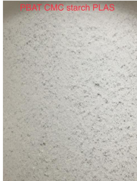
รูปที่ 4.6 ลักษณะของฟิล์มที่เป่าขึ้นรูปจากเม็ดคอมปาวด์ PBAT-CMC,Starch-Plas
