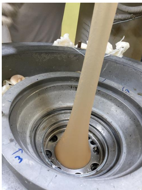
รูปที่ 4.11 การฉีกขาดของฟิล์ม PBAT-CMC-Plas ขณะเป่าขึ้นรูป
