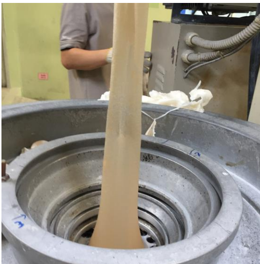
รูปที่ 4.5 ลักษณะของฟิล์มที่เป่าขึ้นรูปจากเม็ดคอมพาวด์ PBAT-CMC-Plas
