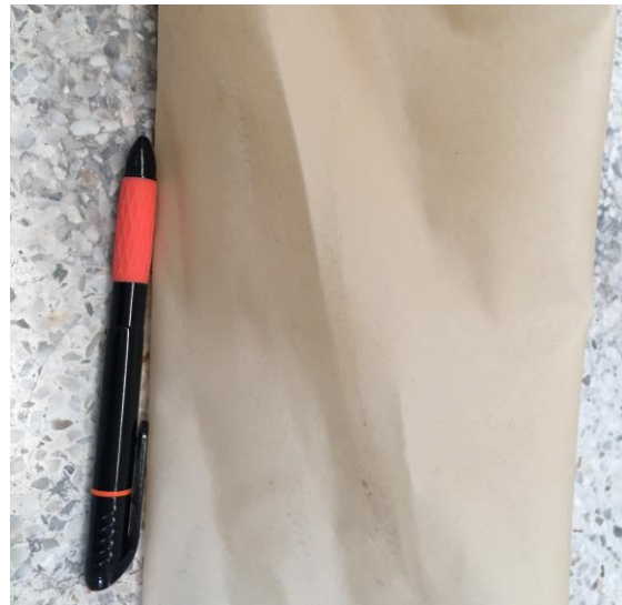
รูปที่ 4.5 ลักษณะของฟิล์มที่เป่าขึ้นรูปจากเม็ดคอมพาวด์ PBAT-CMC-Plas
