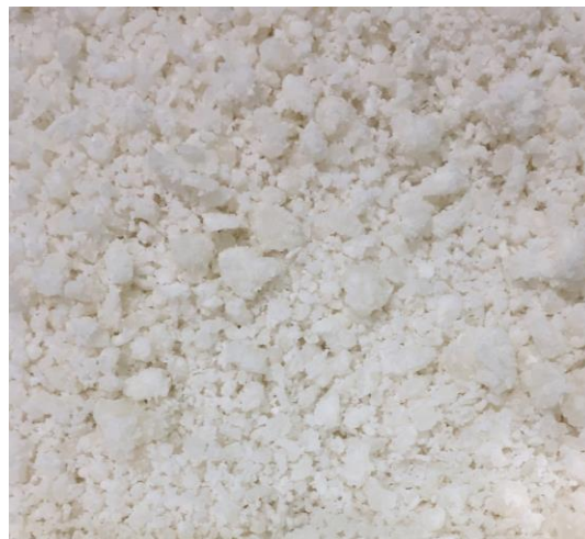
รูปที่ 4.3 การผสมคาร์บอกซีเมทิลเซลลูโลส/กลีเซอรอล/น้ำ ด้วยอัตราส่วน 33.3/33.3/33.3
