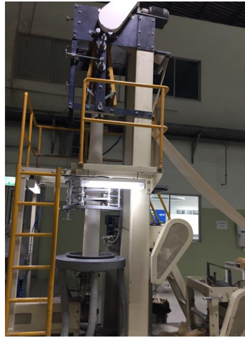
รูปที่ 4.4 การขึ้นรูปฟิล์มจากเม็ดคอมพาวด์ LLDPE-CMC, Starch-Plas
