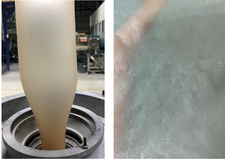
รูปที่ 4.10 ลักษณะของฟิล์มที่เป่าขึ้นรูปจากเม็ดคอมปาวด์ LLDPE-CMC 1-1 TPS
