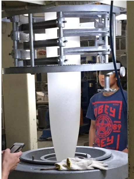
รูปที่ 4.6 ลักษณะของฟิล์มที่เป่าขึ้นรูปจากเม็ดคอมปาวด์ PBAT-CMC,Starch-Plas
