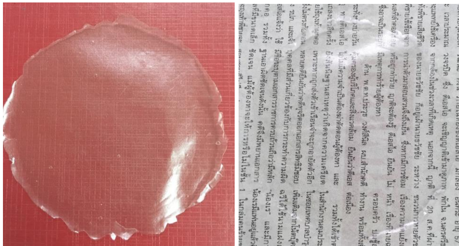
รูปที่ 4.1 ฟิล์มชีวภาพจากคาร์บอกซีเมทิลเซลลูโลสที่เตรียมโดยใช้วิธีการหล่อขึ้นรูปด้วยตัวทำละลายในระดับห้องปฏิบัติการ
