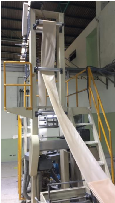
รูปที่ 4.4 การขึ้นรูปฟิล์มจากเม็ดคอมพาวด์ LLDPE-CMC, Starch-Plas
