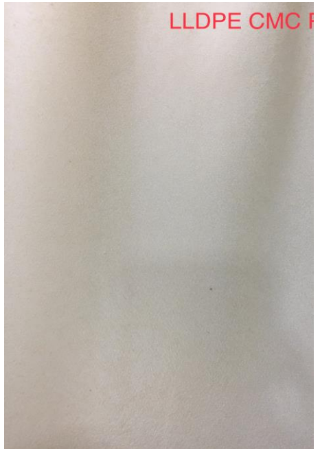
รูปที่ 4.7 ลักษณะของฟิล์มที่เป่าขึ้นรูปจากเม็ดคอมปาวด์ LLDPE-CMC-Plas
