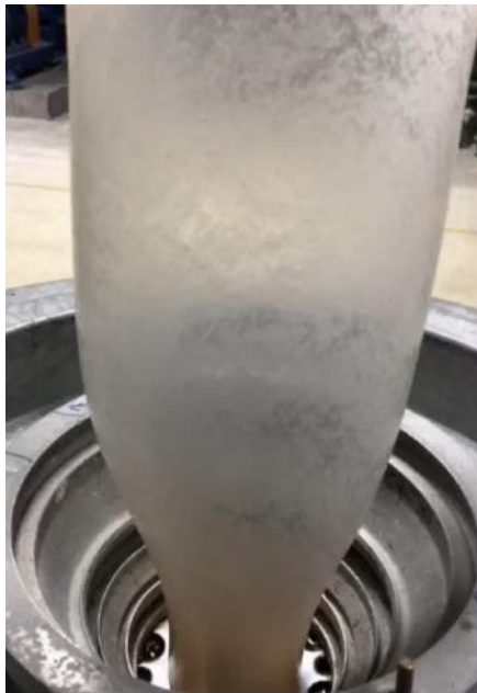
รูปที่ 4.9 ลักษณะของฟิล์มที่เป่าขึ้นรูปจากเม็ดคอมปาวด์ LLDPE-CMC 1-1
