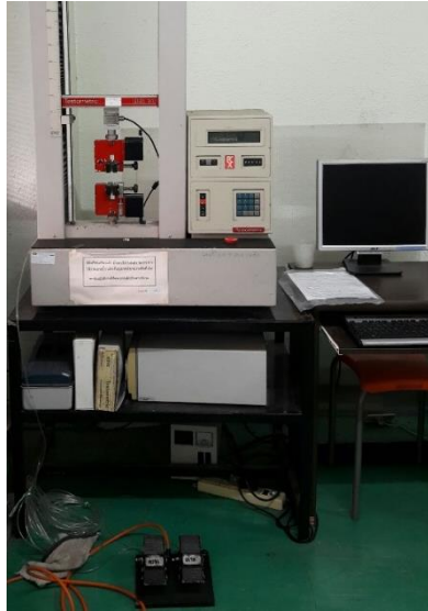
รูปที่ 2.12 เครื่องทดสอบแรงดึง Testometric รุ่น Micro 350
