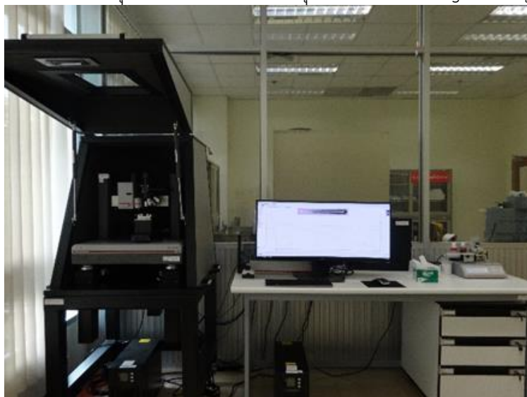
รูปที่ 3.13 เครื่อง Scratch tester ยี่ห้อ/รุ่น Anton Paar/ MST 3
