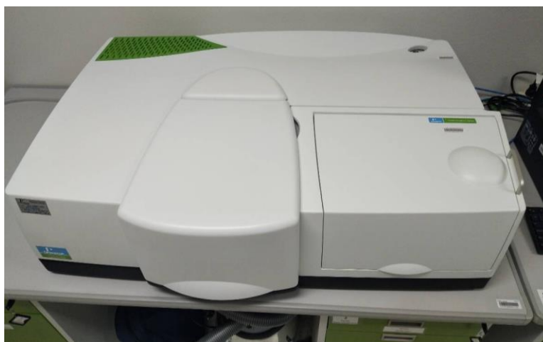
รูปที่ 3.14 เครื่อง UV-Vis Spectrophotometer ยี่ห้อ/รุ่น PerkinElmer/ Lambda 95
