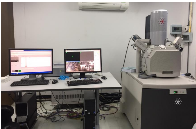
รูปที่ 3.12 เครื่อง Scanning Electron Microscope(FESEM) ยี่ห้อ/รุ่น: FEI / Nova Nanosem 450
