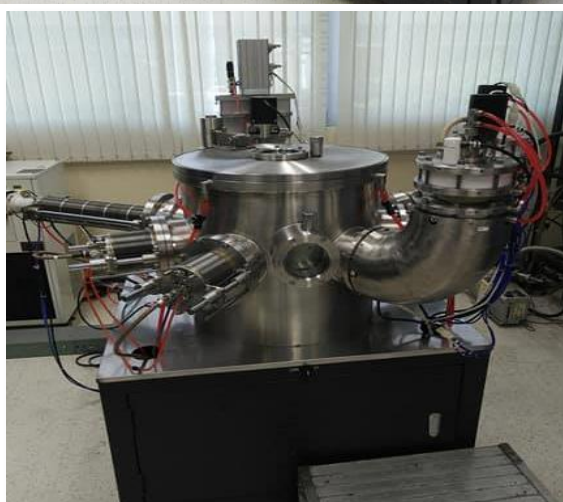
รูปที่ 3.8 เครื่อง FM500 PID Plasma implantation and Deposition System (Non-Thermal plasma)
