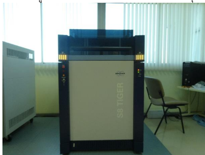
รูปที่ 3.10 เครื่อง Wavelength dispersive X-Ray Fluorescence (WDXRF) ยี่ห้อ/รุ่น: Bruker/S8 TIGER
