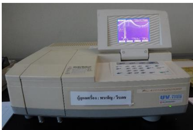
รูปที่ 3.11 เครื่อง UV-Vis Spectrophotometer ยี่ห้อ/รุ่น: Shimadzu / UV-1700
