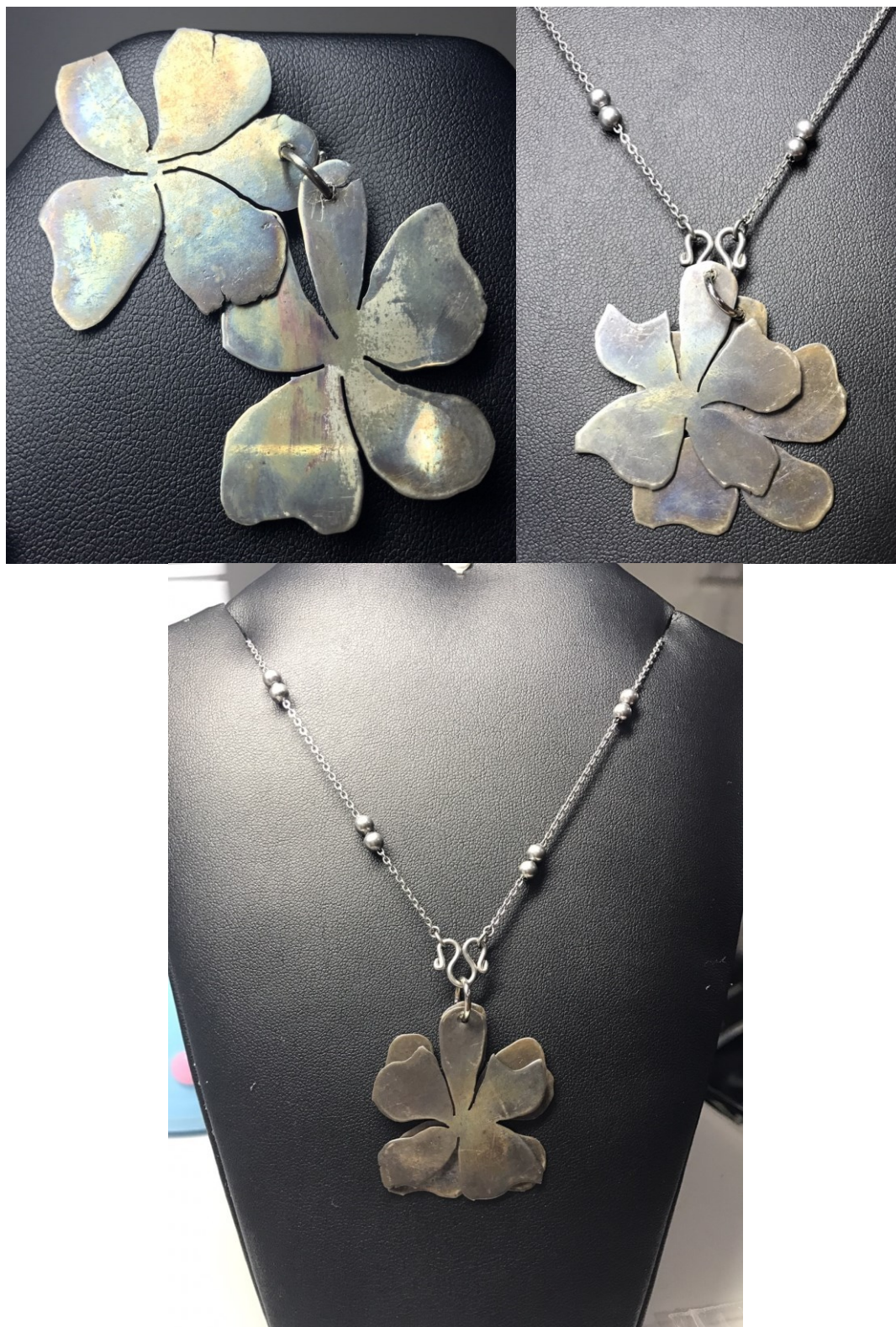
รูปที่ 5.2 เครื่องประดับที่ผ่านการอะโนไดซ์ในซัลเฟอร์และโซเดียมไฮดรอกไซด์ อัตราส่วนที่ 1:1 เวลา 15 วินาที กำลังไฟ 3 โวลต์
