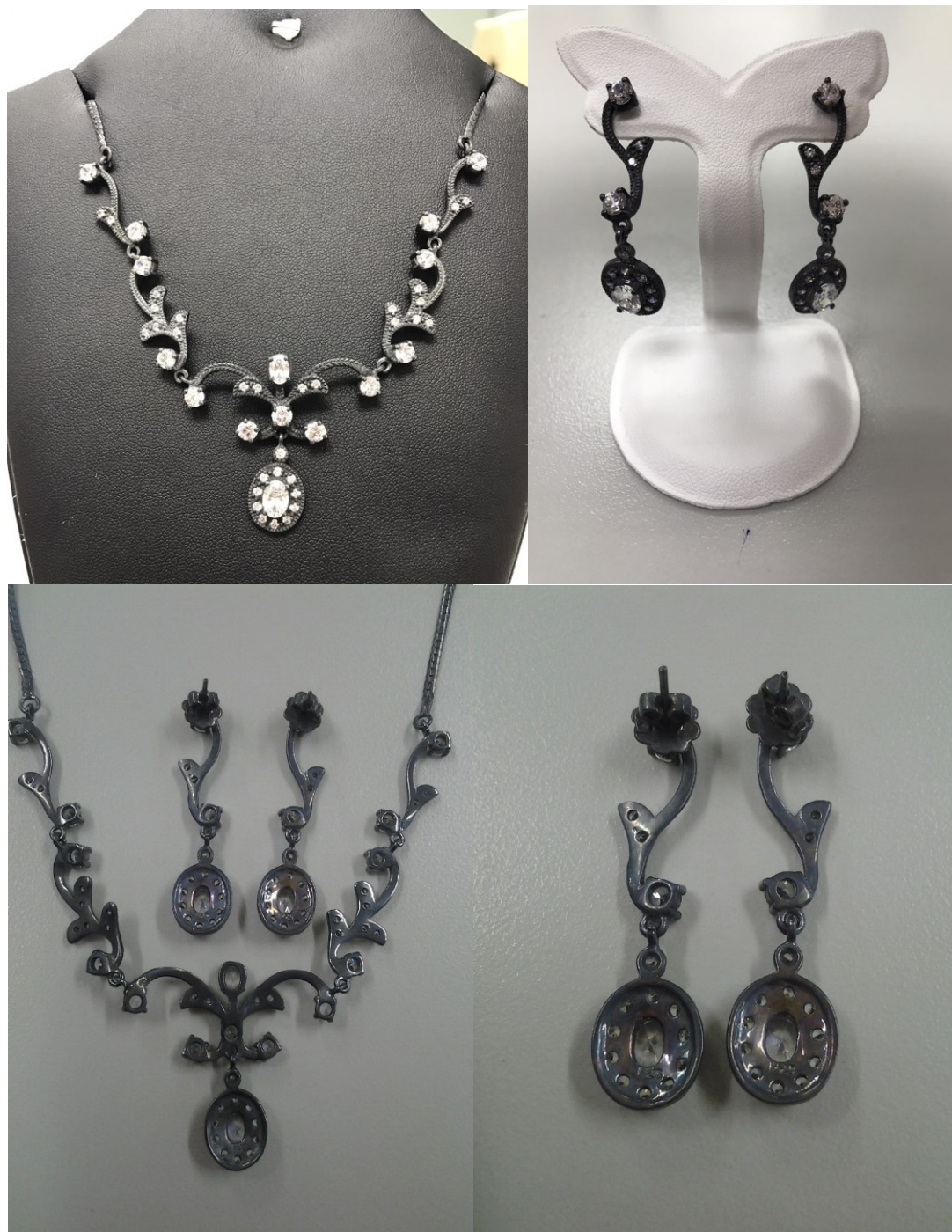
รูปที่ 5.1 เครื่องประดับที่ผ่านการอะโนไดซ์ในซัลเฟอร์และโซเดียมไฮดรอกไซด์ อัตราส่วนที่ 1:2 เวลา 1 วินาที กำลังไฟ 3 โวลต์
