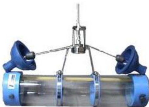
ภาพที่ 2 - 2 กระบอกเก็บน้ำแบบ Van Dorn เพื่อเก็บน้ำวิเคราะห์ธาตุอาหาร และตะกอนแขวนลอยในน้ำ
