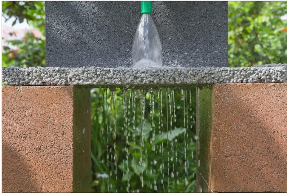
ภาพที่ 4-18 แสดงโครงสร้างที่ยอมให้น้ำไหลผ่านได้ (JJ Harrison, 2011)
