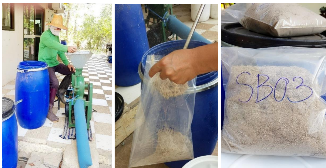
ภาพที่ 2.3 แสดงการบดชานอ้อยเพื่อให้มีขนาดเล็กลง
