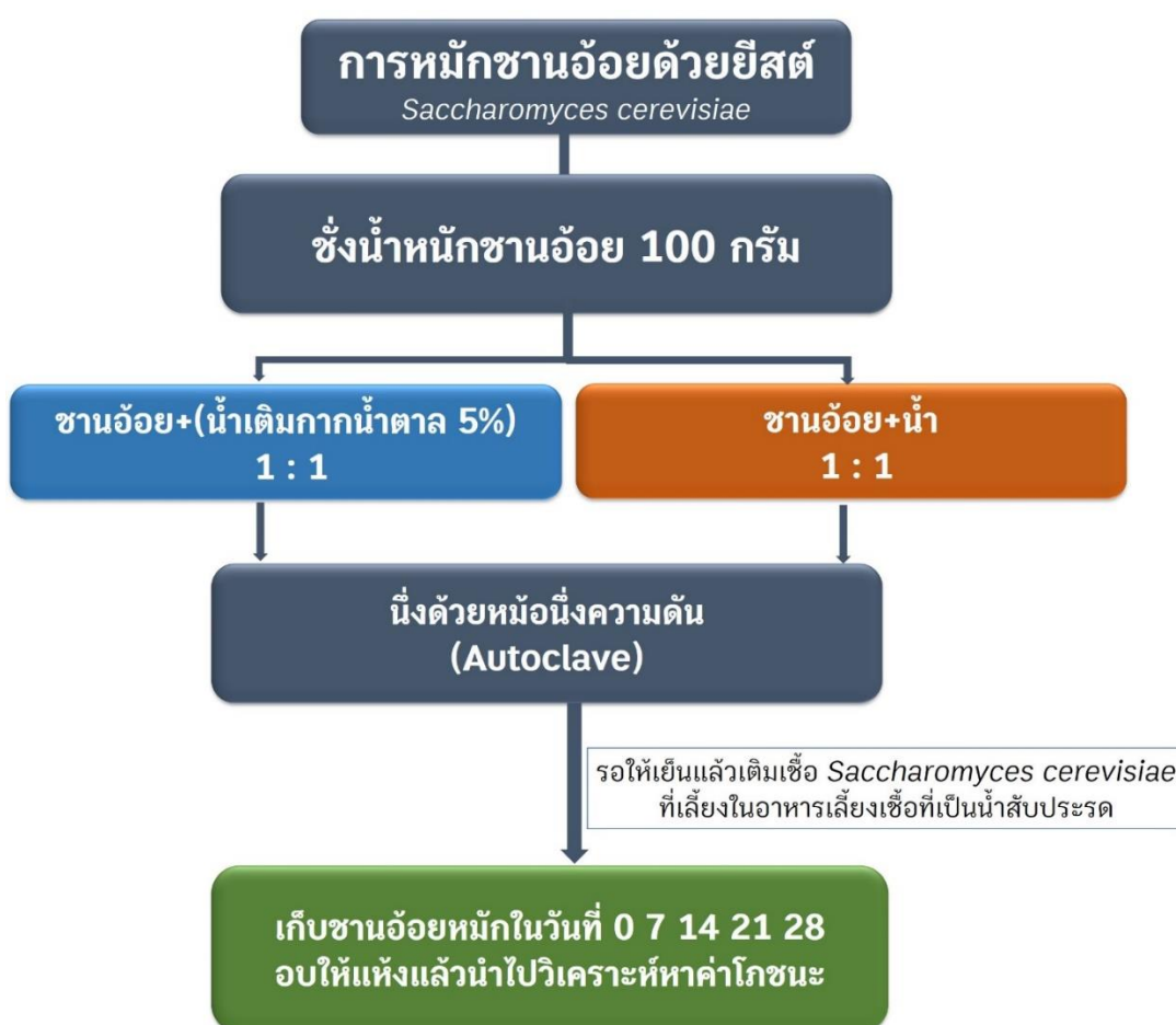
รูปภาพที่ 2.12 ขั้นตอนในการหมักชานอ้อยด้วยยีสต์ Saccharomyces cerevisiae
