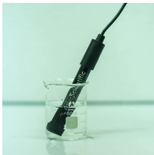
รูปที่ 4.20 วัดค่าปริมาณออกซิเจนของน้ำดื่มและน้ำประปา โดยใช้เซ็นเซอร์วัดค่าปริมาณออกซิเจน
