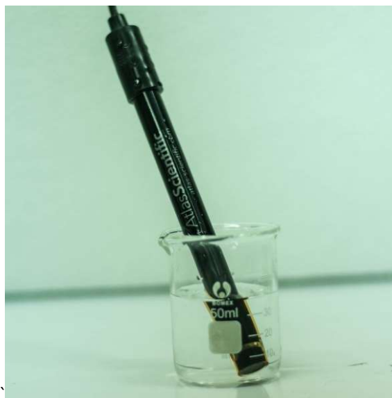
รูปที่ 4.16 วัดค่าความนำไฟฟ้าของน้ำดื่มและน้ำประปา โดยเซ็นเซอร์วัดค่าความนำไฟฟ้า
