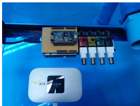
รูปที่ 4.27 ติดตั้งบอร์ดกับ Pocket WiFi ลงอุปกรณ์
