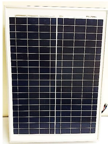
รูปที่ 3.2 แผงโซลาร์เซลล์ขนาด 20 วัตต์
