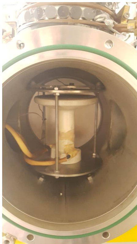
รูปที่ 2.5 ฐานวางชิ้นงานสำหรับเคลือบภายใน Chamber
