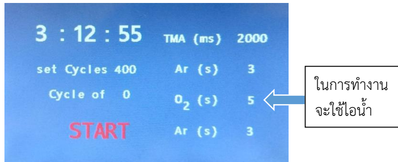
รูปที่ 2.6 หน้าจอควบคุมแสดงผลการป้อนจำนวนรอบการเคลือบและวินาทีของการปล่อยแก๊ส
