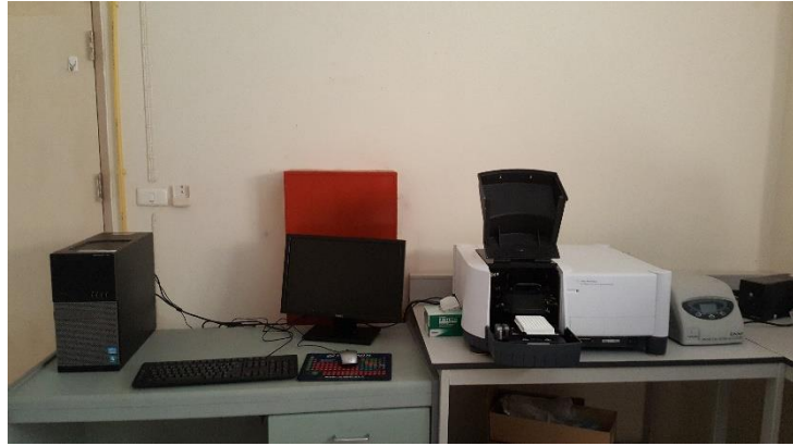
รูปที่ 2.1 เครื่องฟลูออเรสเซนส์สเปกโตรโฟโตมิเตอร์ ยี่ห้อ Agilent รุ่น Cary Eclipse fluorescence spectrometer ที่ติดตั้ง Microplate reader
