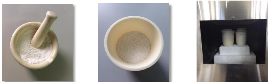
รูปที่ 3.9 การเตรียมส่วนผสมแก้วก่อนนำเข้าเตาหลอมไฟฟ้า
