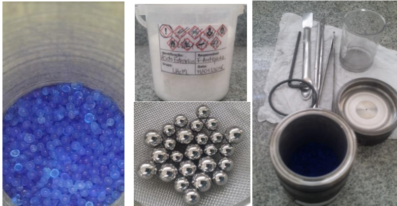
ซิลิกาเจล และกรดอะซิติก ในการทำความสะอาดลูกบด และ หม้อบดสำหรับ เครื่อง FRITSCH P6 planetary ball mill
