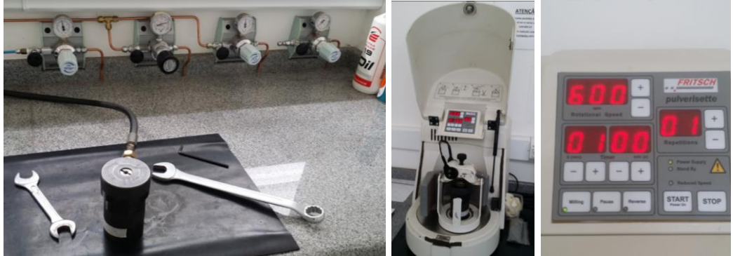
การติดตั้งก๊าชอาร์กอนเข้าสู่หม้อบดที่บรรจุวัสดุ เครื่อง FRITSCH P6 planetary ball mill และแผงควบคุม
