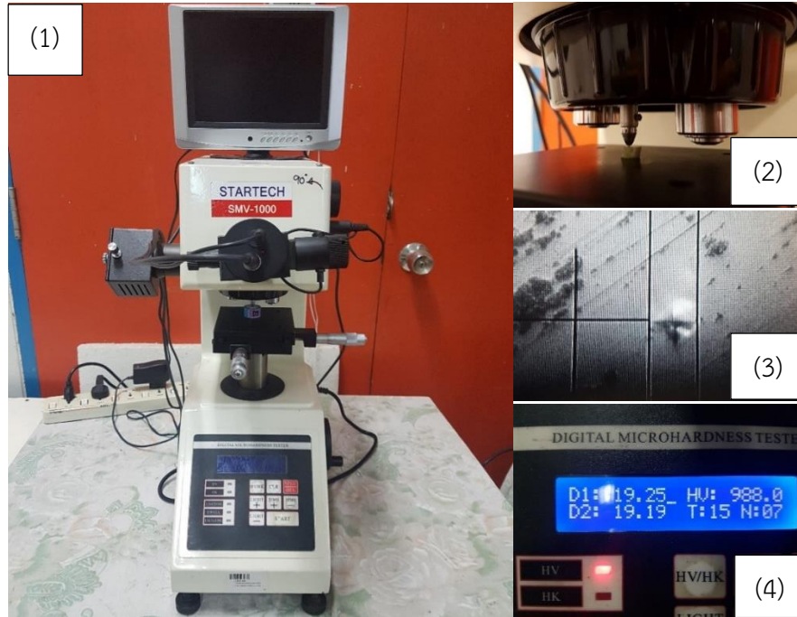
รูปที่ 2.15 เครื่องวัดค่าความแข็ง micro Vickers hardness
