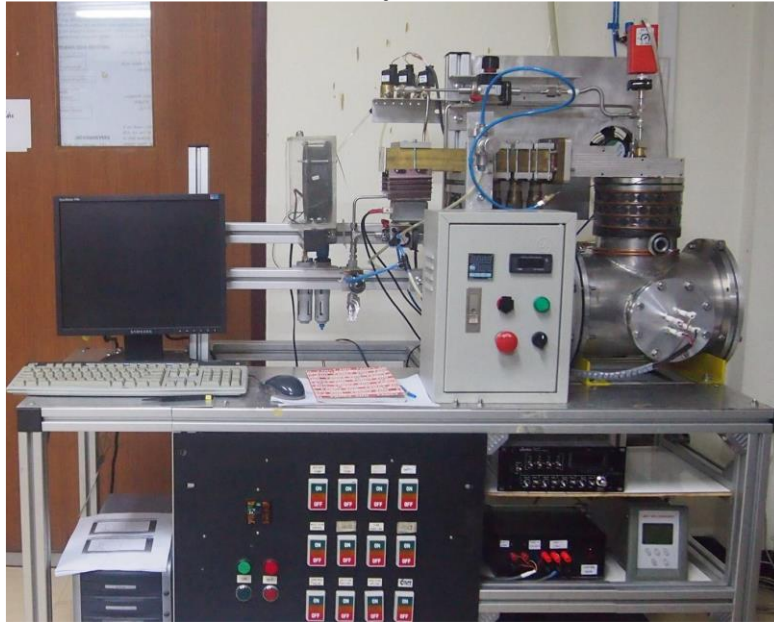
รูปที่ 2.2 เครื่องเคลือบ Plasma Enhance Atomic layer Deposition (PE-ALD)
