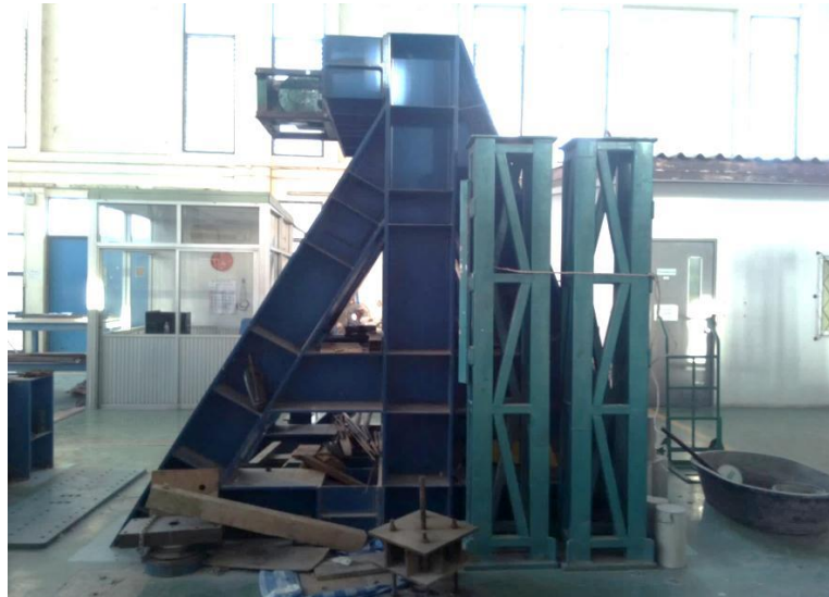
รูปที่ 3.7 โครงสร้างรับแรงปฏิกิริยา (Reaction frame)
