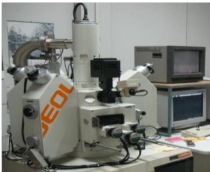
รูปที่ 2.3 เครื่องอิเล็กตรอนโพรบไมโครแอนาไลซิส (Electron Probe Microanalysis: EPMA) (ภาควิชาธรณีวิทยา คณะวิทยาศาสตร์ จุฬาลงกรณ์มหาวิทยาลัย, 2562)
