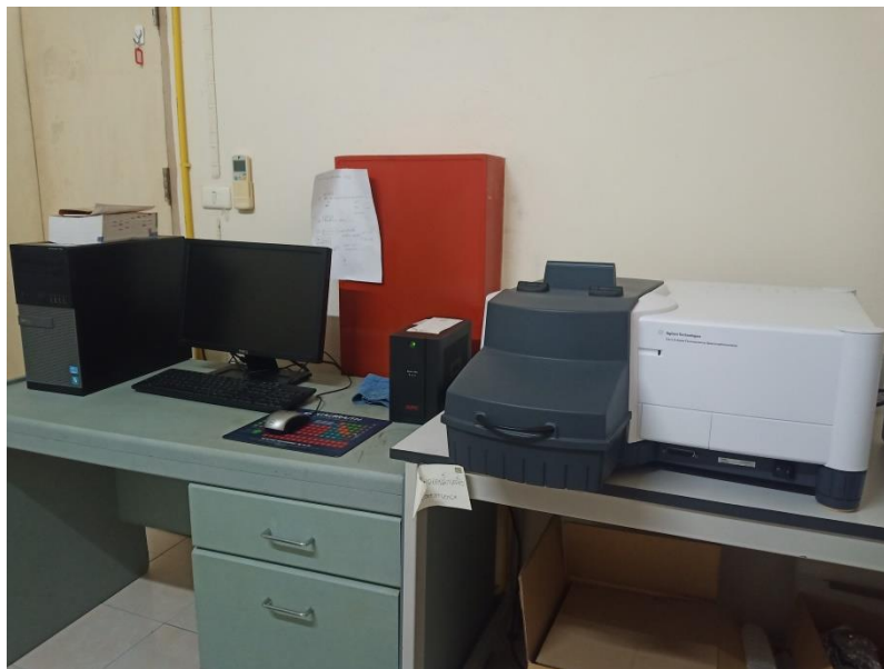
รูปที่ 2.5 เครื่องฟลูออเรสเซนส์ สเปกโตรโฟโตมิเตอร์ (Fluorescence Spectrophotometer)
