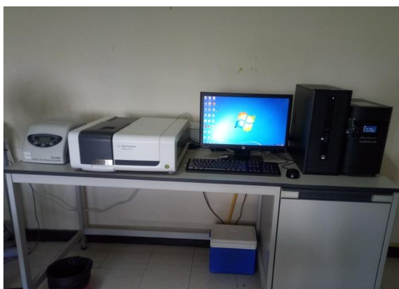
รูปที่ 2.4 เครื่องยูวี-วิสิเบิล สเปกโตรโฟโตมิเตอร์ (UV-Visible Spectrophotometer)
