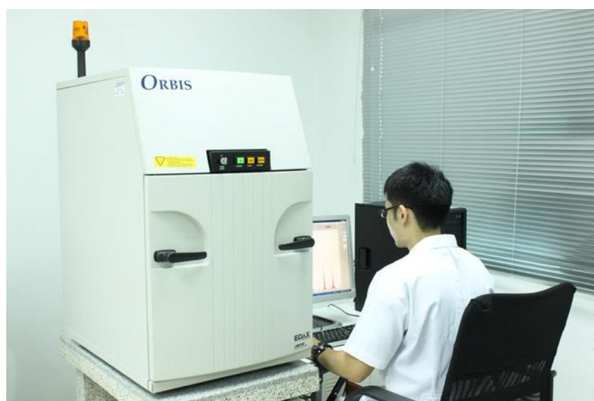
รูปที่ 2.2 เครื่องเอกซเรย์ ฟลูออเรสเซนซ์ (X-Ray Fluorescence) ยี่ห้อ EDAX Ametek รุ่น Orbis
