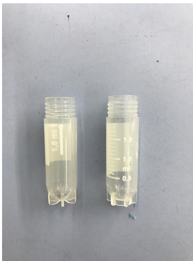
รูปที่ 4 หลอด Cryovial ขนาด 1.8 มิลลิลิตรที่ใช้ในการทดลอง
