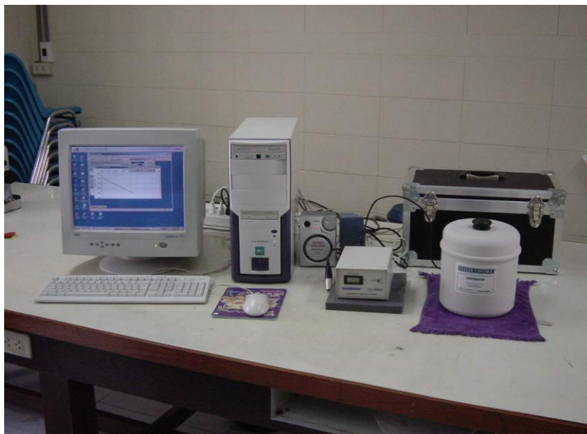
รูปที่ 3 เครื่องมือแช่แข็งน้ำเชื้ออัตโนมัติ
