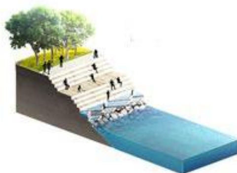
ตลิ่งแบบโครงสร้าง คสล. เมื่อน้ำต่ำสุด
