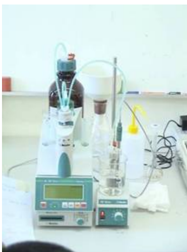
รูปที่ 3.6 เครื่อง Potentiometric titration และเครื่องกวนแม่เหล็ก
