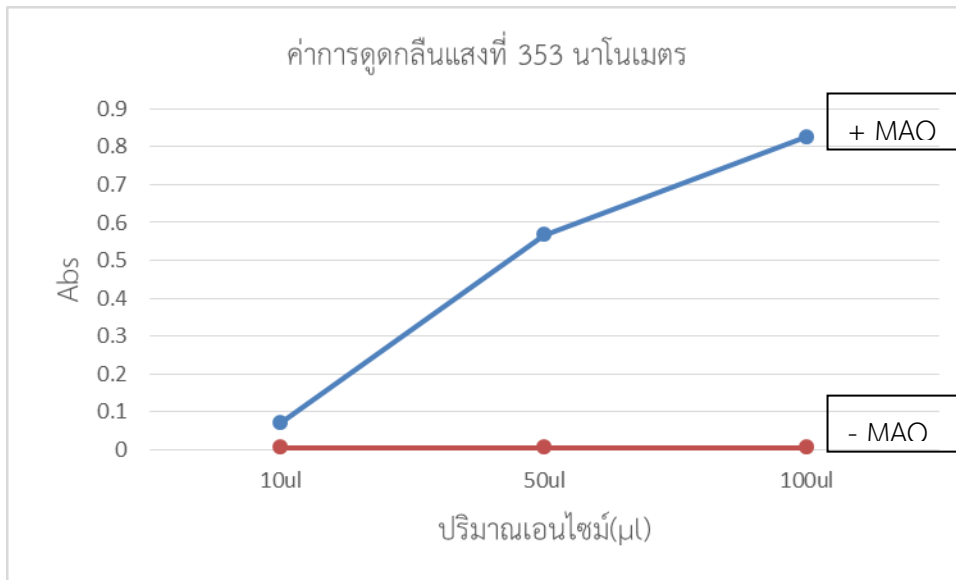
ภาพที่ 4-4 ค่าการดูดกลืนแสงที่ 353 นาโนเมตรของการทดสอบตรวจติดตามการเกิดผลิตภัณฑ์ H_2O_2 ด้วยสารละลาย KI ซึ่งจะทำให้การหยุดปฏิกิริยาด้วย 2N HCl ที่เวลา 30 นาที
