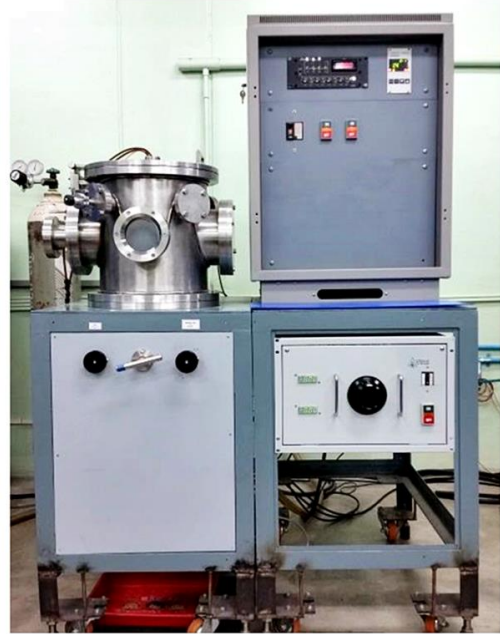
ภาพที่ 3-1 ไดอะแกรมและลักษณะของเครื่องเคลือบสุญญากาศระบบสปัตเตอร์ิ่งที่ใช้ในงานวิจัย
