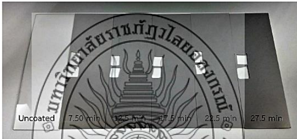
ภาพที่ 4 ลักษณะของฟิล์มบางโครเมียมชุดที่ 2 สำหรับทดสอบแบบจำลองทางคณิตศาสตร์
