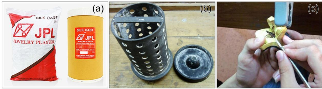
รูปที่ 2.3 (a) ปูนหล่อเครื่องประดับ (b) เบ้าโลหะและฐานยาง และ (c) คีมจับและมีดผ่าตัดในการผ่าแม่พิมพ์ยาง
