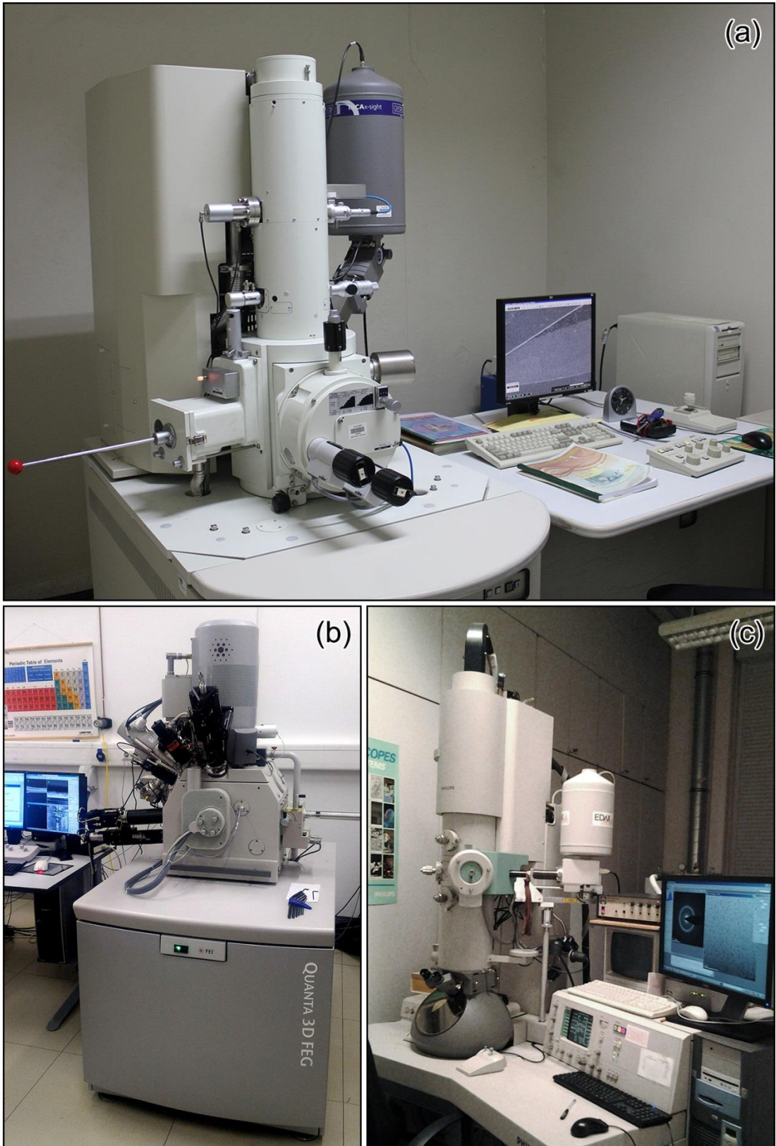
รูปที่ 2.5 เครื่องมือขั้นสูงในการศึกษาโครงสร้างจุลภาคและการเตรียมตัวอย่าง (a) กล้องจุลทรรศน์อิเล็กตรอนแบบส่องกราด (b) เครื่องโฟกัสไอออนบีม และ (c) กล้องจุลทรรศน์อิเล็กตรอนแบบส่องผ่าน
