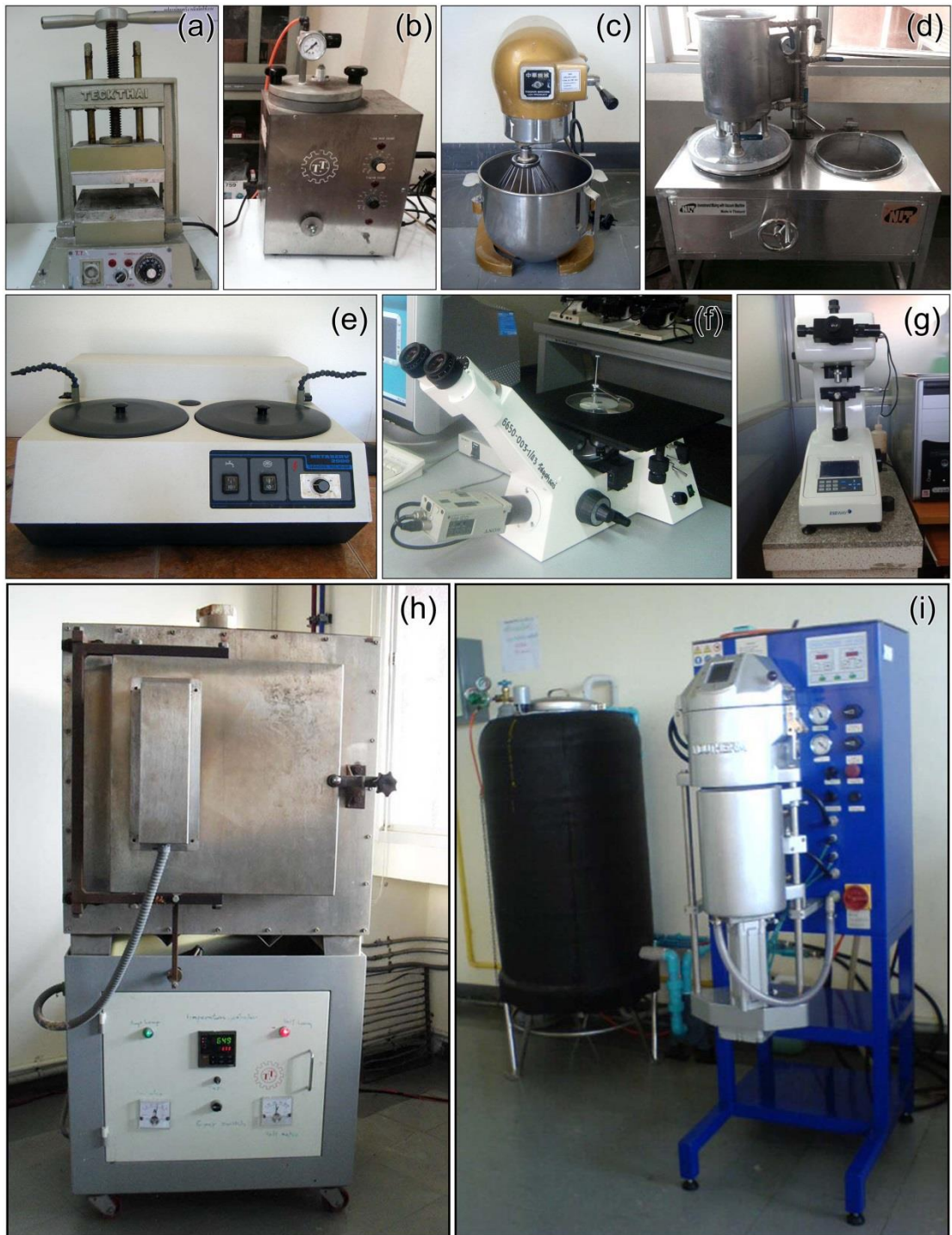
รูปที่ 2.4 เครื่องมือในการเตรียมตัวอย่างและการศึกษาโครงสร้างจุลภาคเบื้องต้น (a) เครื่องอัดแม่พิมพ์ยาง (b) เครื่องฉีดยุท (c) เครื่องผสมปูน (d) เครื่องดูดสุญญากาศสำหรับเบ้าปูน (e) เครื่องขัดตัวอย่างแบบสองจาน (f) กล้องจุลทรรศน์แบบแสง (g) เครื่องวัดความแข็งแบบวิกเกอร์ (h) เตาอบเบ้าปูน และ (i) เครื่องหล่อโลหะแบบขดลวดเหนี่ยวนำ
