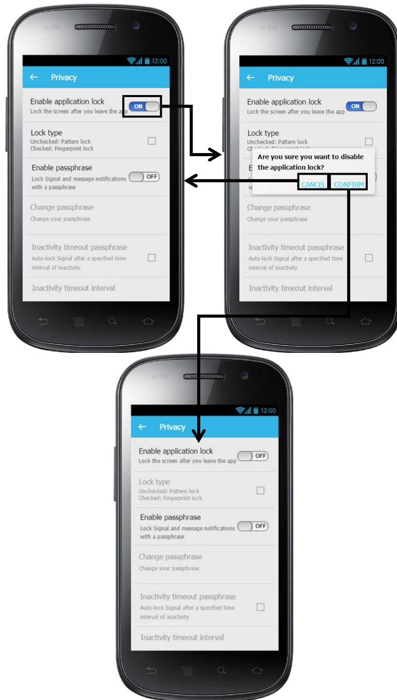
รูปที่ 3-66 Wireframe และ Flow ของ App เมื่อผู้ใช้เปลี่ยนสถานะปุ่ม Enable application lock จาก ON เป็น OFF
