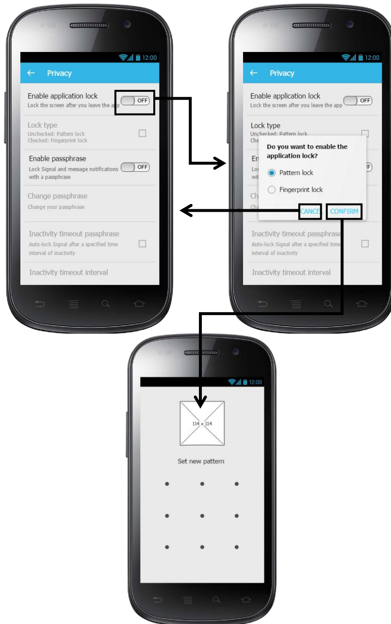
รูปที่ 3-63 Wireframe และ Flow ของ App เมื่อผู้ใช้เปลี่ยนสถานะปุ่ม Enable application lock จาก OFF เป็น ON
