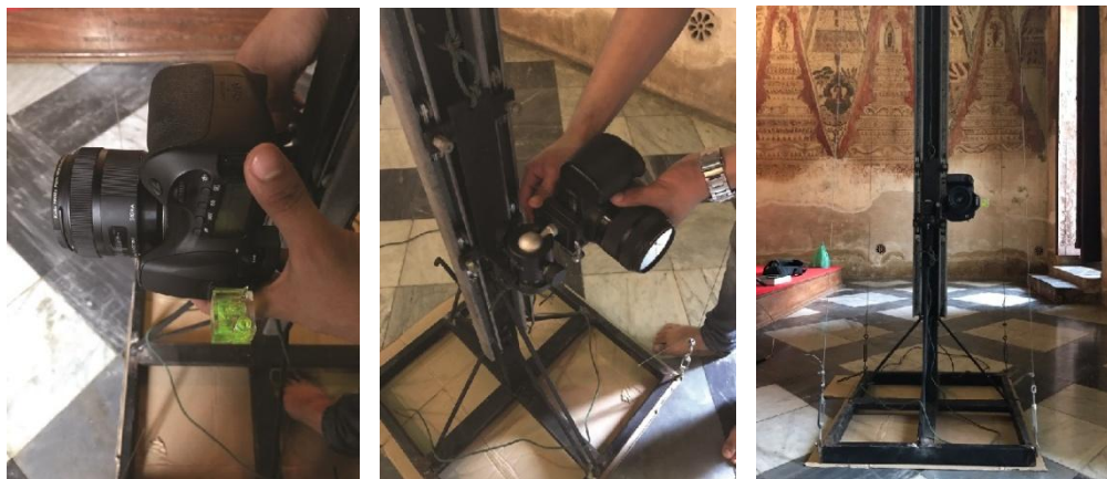
ภาพที่ 4.9 การติดตั้งกล้องถ่ายภาพ
