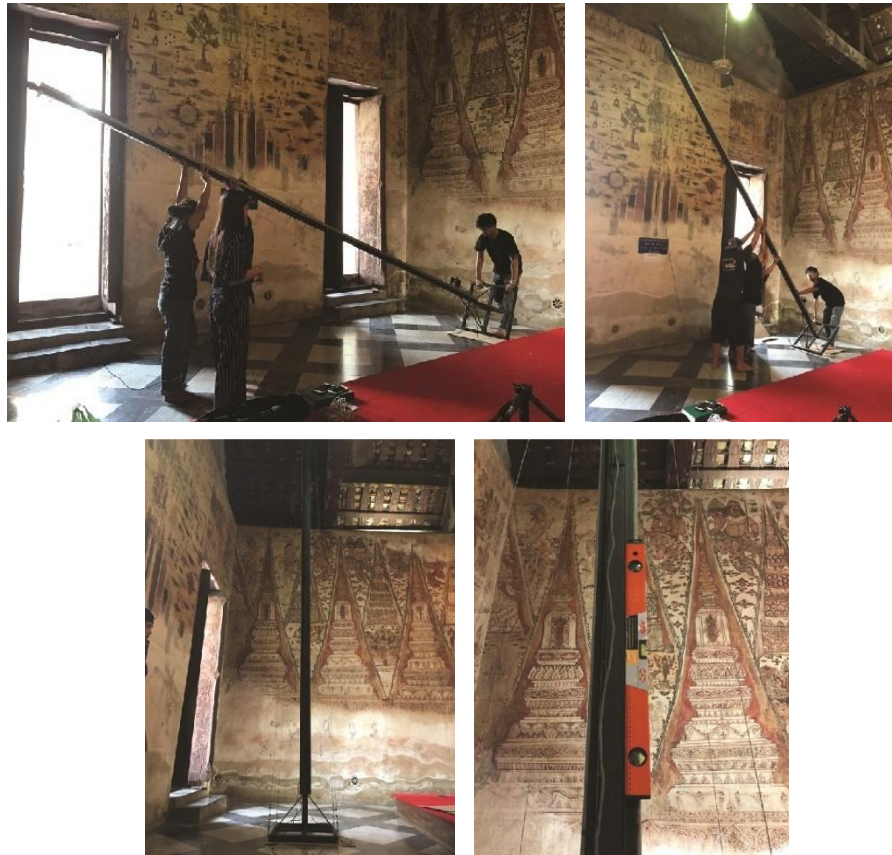
ภาพที่ 4.8 ภาพการนำอุปกรณ์ตั้งขึ้นเพื่อวัดระดับแนวตั้งฉากกับพื้น
