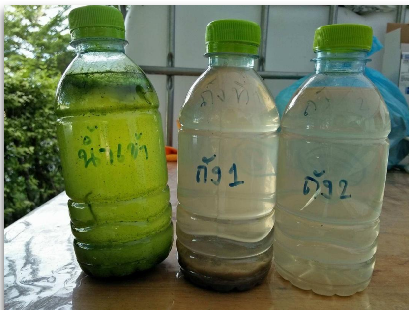
รูปที่ 5.8 ตัวอย่างน้ำเข้า น้ำออกจากถังที่ 1 น้ำออกจากถังที่ 2 และตะกอนของน้ำถังที่ 1 และ 2 หลังจากวางไว้สองอาทิตย์ พบว่าน้ำเสียที่ยังไม่ผ่านการบำบัดเปลี่ยนเป็นสีเขียวเนื่องจากการเติบโตของพืชน้ำ
