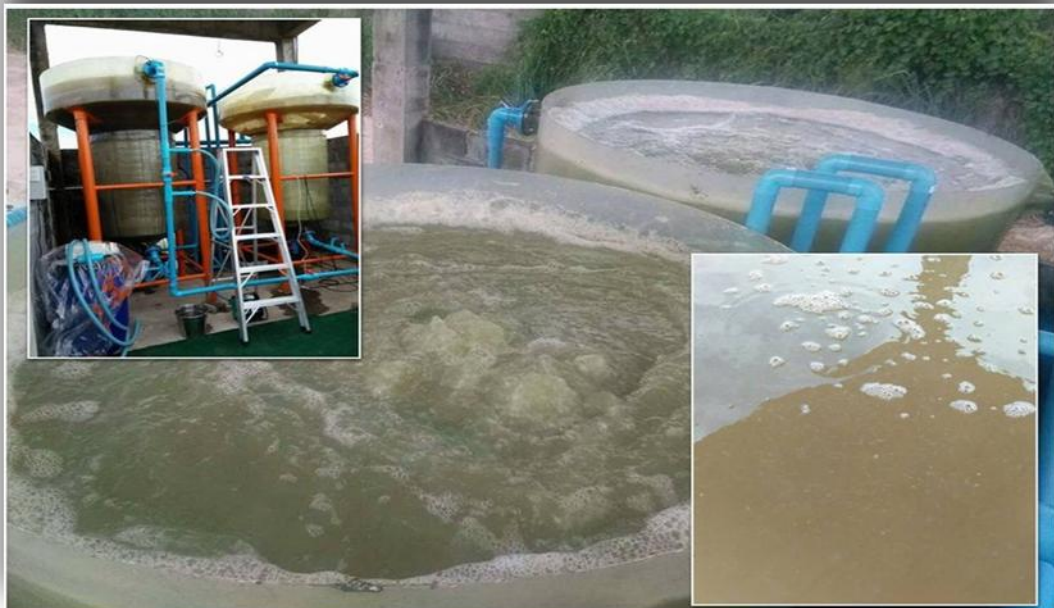
รูปที่ 5-5 แสดงการตกผลึกปัญสตอร์ไวท์ระหว่างการเดินระบบ
