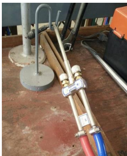
รูปที่ 3.5 อุปกรณ์การเผาชิ้นงานและให้ความร้อน
