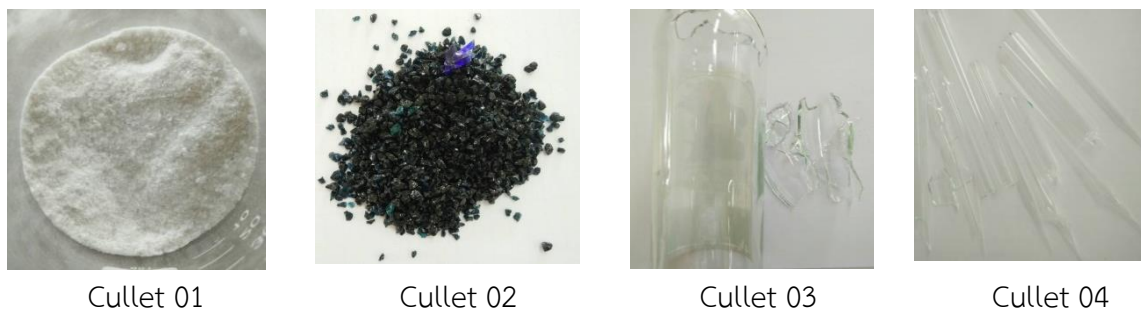
รูปที่ 3.2 แก้วเหลือใช้จากอุตสาหกรรม 4 ชนิด
