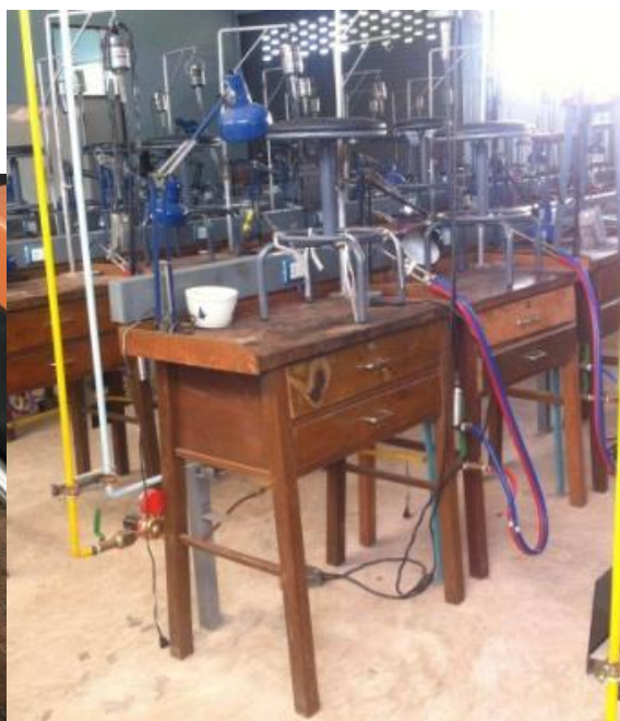
รูปที่ 3.5 อุปกรณ์การเผาชิ้นงานและให้ความร้อน
