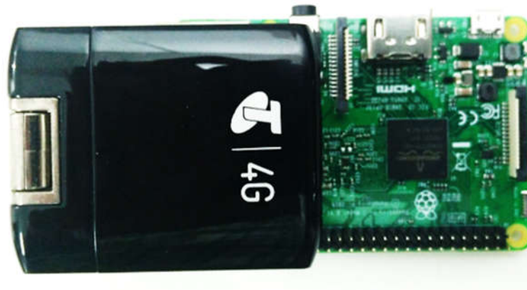
ภาพที่ 4.3 การต่อหน่วยประมวลผลกับหน่วยสื่อสารทางช่องทาง USB
