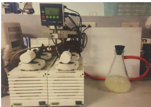
ภาพที่ 3-4 ลักษณะการต่อเชื่อมอุปกรณ์ในการออสโมซิสสภาวะสุญญากาศ
