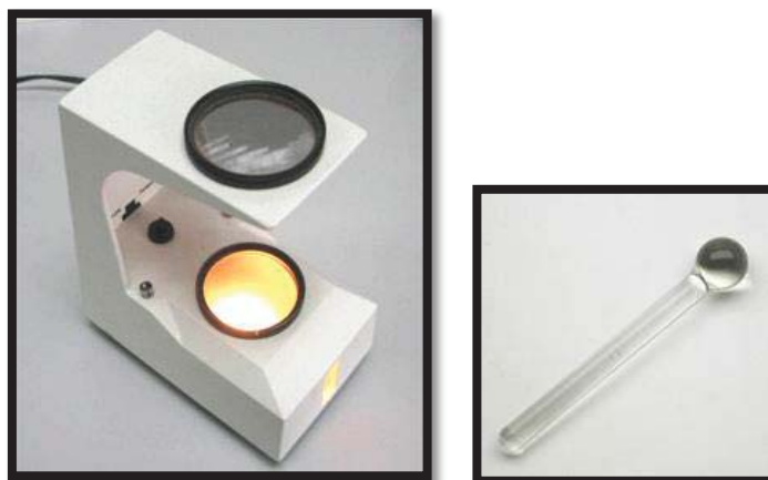
รูป 3.2 เครื่องโพลาริสโคป (Polariscope) และ Condensing Sphere (Burapha Gemological Laboratory, 2015 [On-line])
