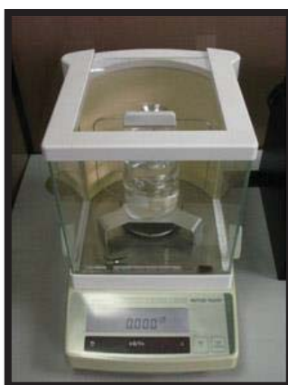
รูป 3.3 เครื่องชั่งหาความถ่วงจำเพาะ (Hydrostatic Weighing Balance) (Burapha Gemological Laboratory, 2015)
