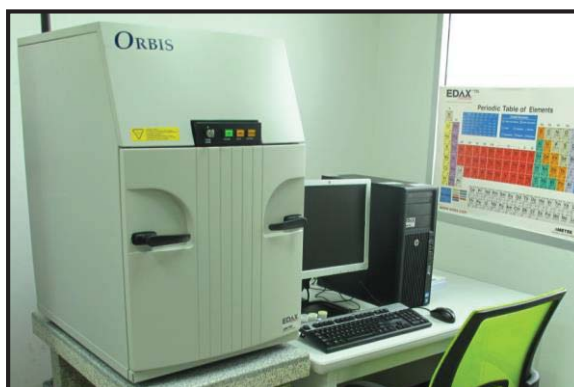
รูป 3.6 เครื่อง Energy Dispersive X-Ray Fluorescence Spectrometer (EDXRF) ยี่ห้อ EDAX รุ่น ORBIS PC ที่ Burapha Gemological Laboratory
