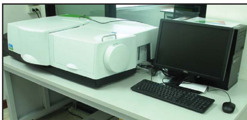
รูป 3.5 เครื่อง UV-Vis-NIR Spectrophotometer ยี่ห้อ PerkinElmer รุ่น Lambda 1050 ที่ Burapha Gemological Laboratory
