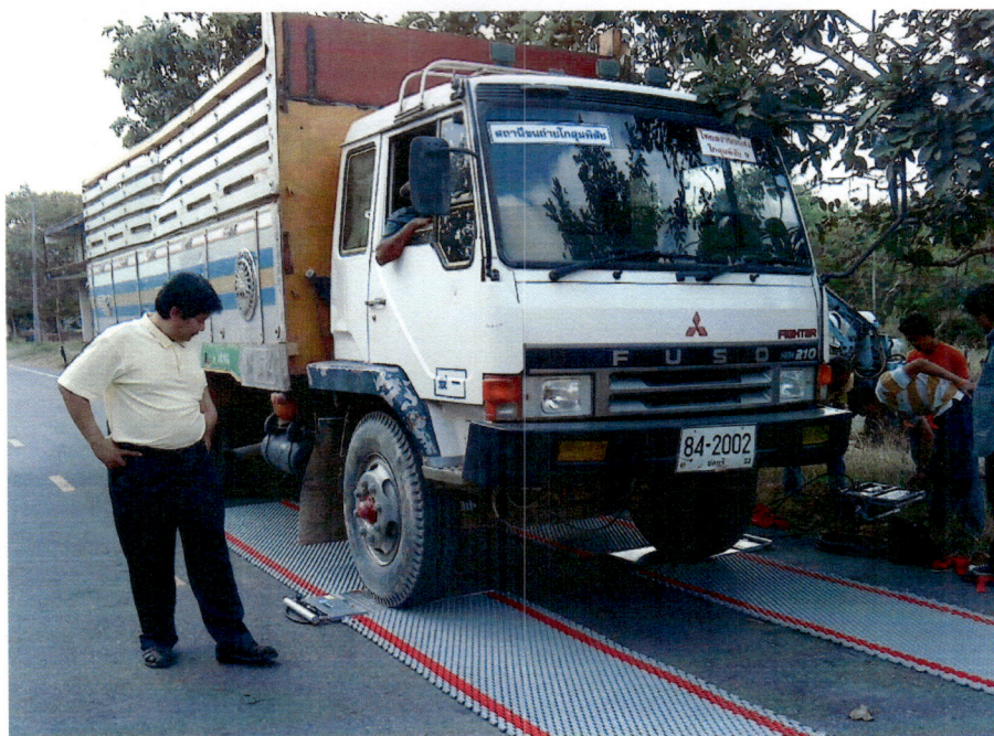
รูปที่ 3.2 การชั่งน้ำหนักของรถบรรทุกที่ใช้ในการทดสอบโดยตาชั่งลอย
