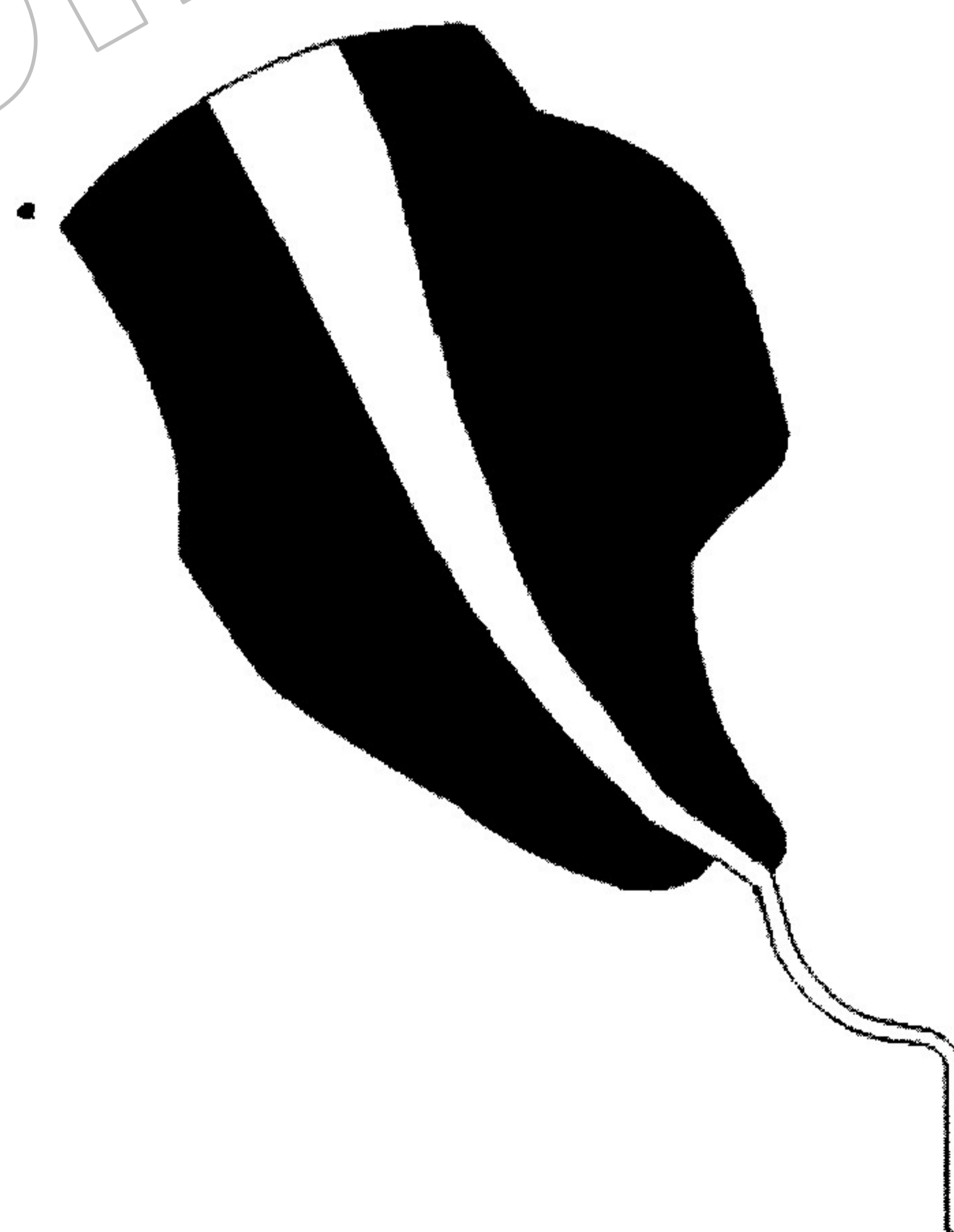
ภาพที่ 4 การแบ่งพื้นที่ในแบบจำลองเพื่อกำหนดตัวเลขเพกเลต ค่าความขรุขระของแมนนิ่ง และสัมประสิทธิ์การผสมผสานแบบปั่นป่วน ประกอบด้วยพื้นที่สีดำแสดงพื้นที่น้ำตื้นในอ่าวและพื้นที่สีขาวแสดงบริเวณร่องน้ำในอ่าวปากพนังและแม่น้ำปากพนัง
