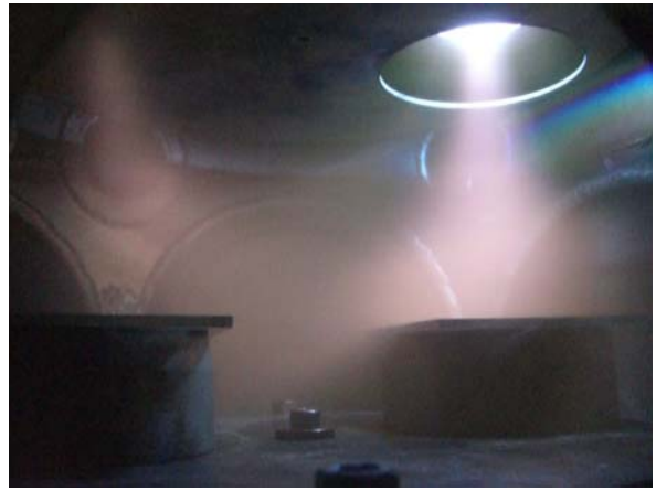
ภาพที่ 8 ต้นแบบเครื่องเคลือบในสุญญากาศระบบสเปดเตอริงสำหรับเตรียมฟิล์มบางที่มีความหนาในระดับนาโน
