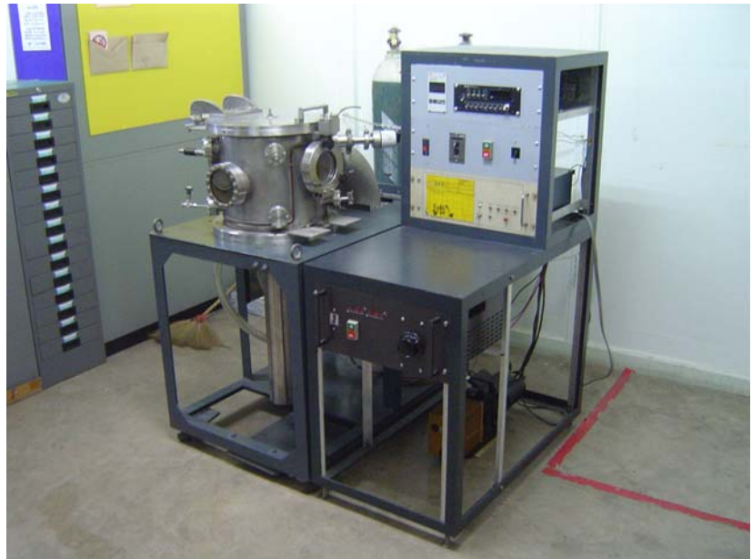
รูปที่ 9 ต้นแบบเครื่องเคลือบในสุญญากาศระบบสเปดเตอริงสำหรับเคลือบแข็งชิ้นส่วนเครื่องจักร
