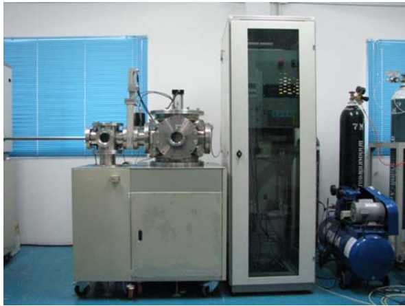
ภาพที่ 8 ต้นแบบเครื่องเคลือบในสุญญากาศระบบสเปดเตอริงสำหรับเตรียมฟิล์มบางที่มีความหนาในระดับนาโน
