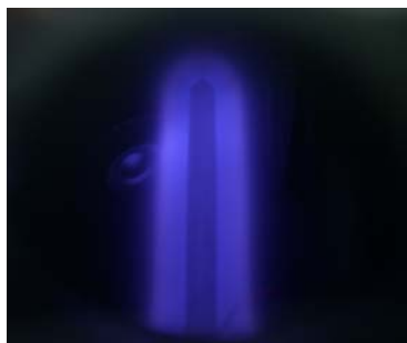
รูปที่ 9 ต้นแบบเครื่องเคลือบในสุญญากาศระบบสเปดเตอริงสำหรับเคลือบแข็งชิ้นส่วนเครื่องจักร
