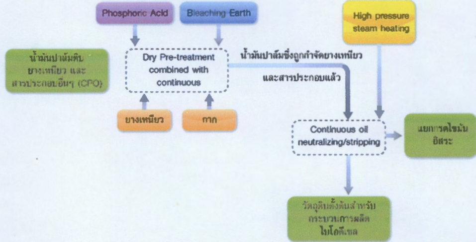
ภาพที่ 2.17 กระบวนการเตรียมและปรับสภาพน้ำมันปาล์มดิบเพื่อใช้เป็นวัตถุดิบตั้งต้นสำหรับผลิตไบโอดีเซล (เพียวไบโอดีเซล, ม.ป.ป.)
