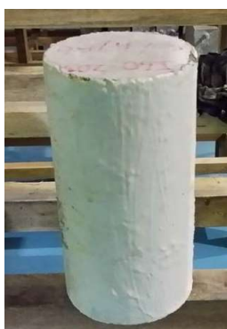
รูปที่ 3.41 ลักษณะคอนกรีตทรงกระบอกขนาดเส้นผ่านศูนย์กลาง 10 cm สูง 20 cm ที่ทำการเคลือบอีพ็อกซี โดยยกเว้นบริเวณผิวหน้าตัดด้านบน
