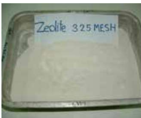
รูปที่ 2.7 ผงซีโอไลต์ธรรมชาติ (ที่มา : ชัยณรงค์ จันทร์มณ และ ดนุพล ตันนโยภาส, 2556)
