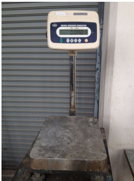
รูปที่ 3.15 เครื่องชั่งดิจิตอล ละเอียด 0.005 kg
