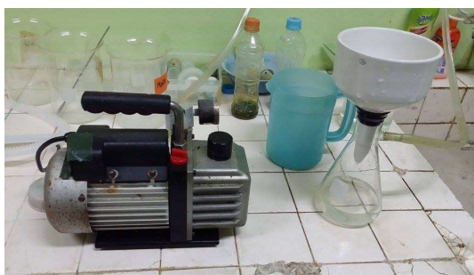
รูปที่ 3.43 การประกอบเครื่องดูดเข้ากับกรวยด้วยสายยางและนำปลายกรวยเสียบเข้ากับขวดแก้วกันโปรง
