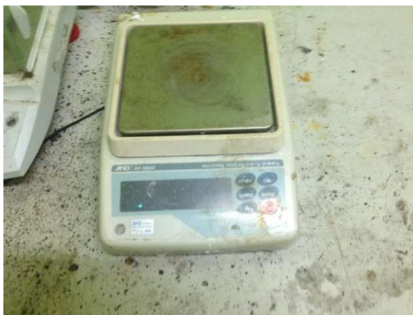
รูปที่ 3.16 เครื่องชั่งดิจิตอล ละเอียด 0.001 g
