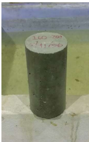
รูปที่ 3.33 ลักษณะคอนกรีตทรงกระบอกขนาดเส้นผ่านศูนย์กลาง 10 cm สูง 20 cm ที่แข็งตัวแล้ว
