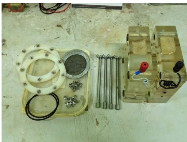
รูปที่ 3.18 ส่วนประกอบของเซลล์ทดสอบ
