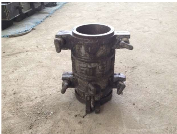
รูปที่ 3.13 แบบหล่อตัวอย่างคอนกรีตทรงกระบอกขนาดเส้นผ่านศูนย์กลาง 10 cm สูง 20 cm
