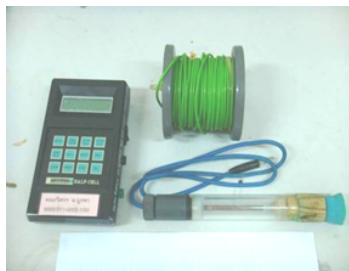
ภาพที่ 3-15 ชุดทดสอบศักย์ไฟฟ้าครึ่งเซลล์ (Half-cell potentials)
