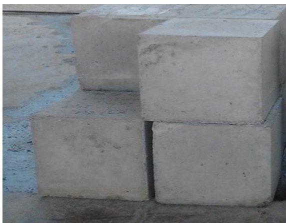
ภาพที่ 3-22 ตัวอย่างคอนกรีตทรงลูกบาศก์ขนาด 10 \times 10 \times 10 ลูกบาศก์เซนติเมตร
