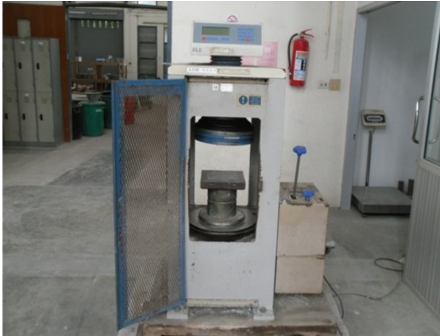
ภาพที่ 3-23 เครื่องทดสอบกำลังอัดคอนกรีตขนาด 30 ตัน ยี่ห้อ ELE
