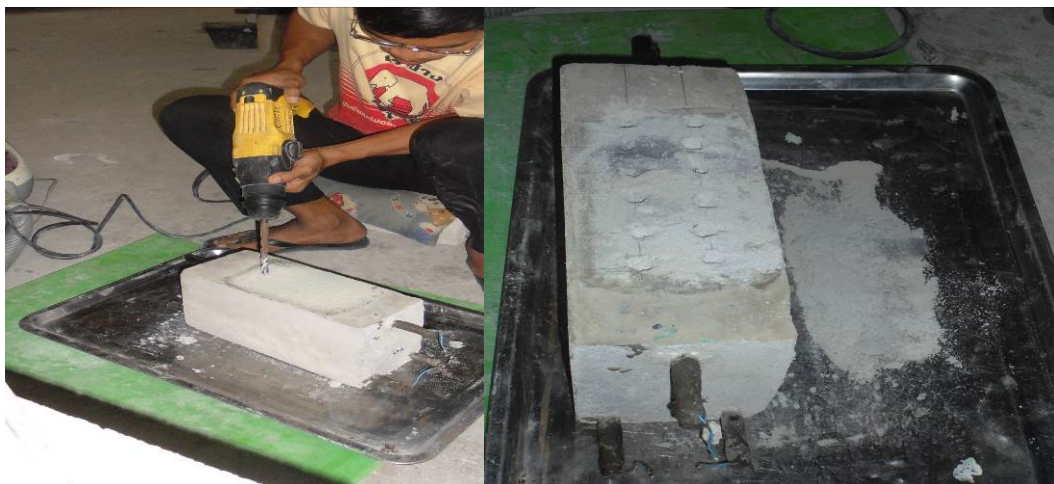
ภาพที่ 3-20 การเก็บตัวอย่างผงปูนเพื่อนำไปหาค่าระดับคลอไรด์วิกฤตที่ระดับความลึกต่าง ๆ
