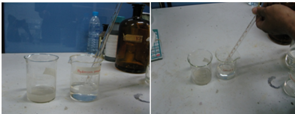
ภาพที่ 3-11 การเติมสารละลายกรดไนตริกลงในตัวอย่าง
