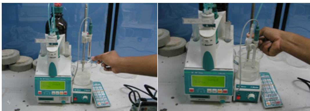
ภาพที่ 3-12 การใช้เครื่อง Auto titration
