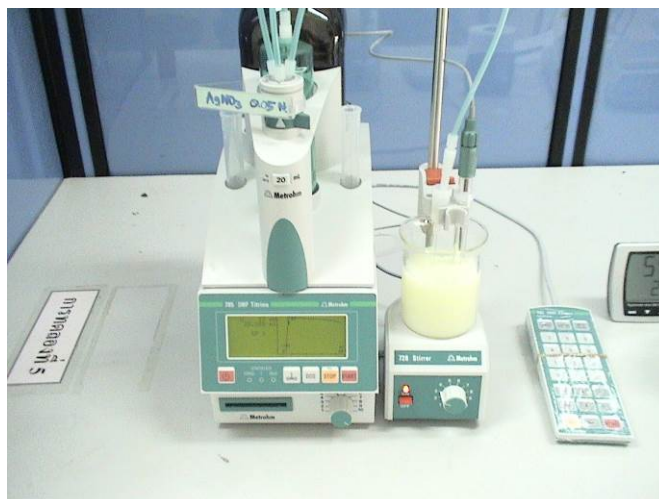
ภาพที่ 3.11 การไตเตรทหาปริมาณคลอไรด์
