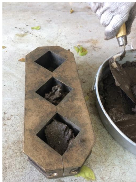
(ข) ใส่จีโอพอลิเมอร์มอร์ตาร์ในแบบหล่อทุกช่อง
