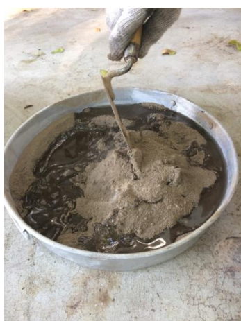
(ง) คลุกเคล้าส่วนผสมให้เข้าเป็นเนื้อเดียวกัน
