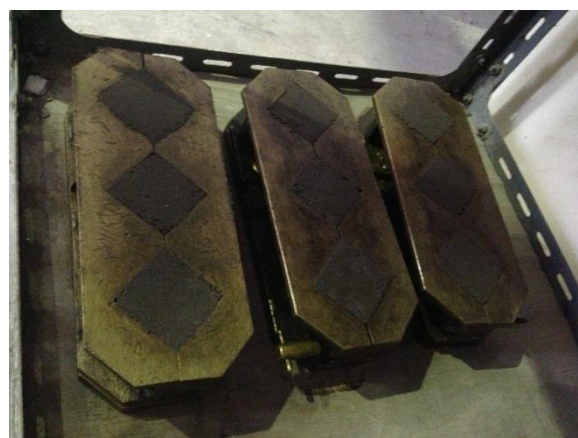
(จ) นำจีโอพอลิเมอร์มอร์ต้าที่ผสมเสร็จแล้วเข้าแบบหล่อ
