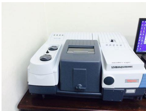
รูปที่ 2.1 เครื่องอินฟราเรดสเปกโตรสโคปี (Fourier Transform Infrared Spectrometer รุ่น Nico- let 4700, Thermo, Electron Cooperation, USA)
