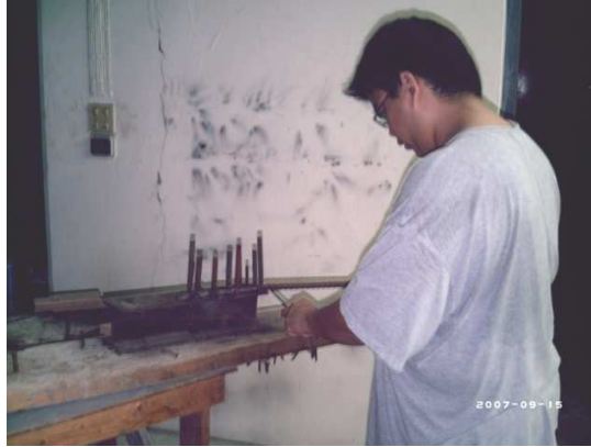
รูปที่ 3.26 การตัดเหล็กเสริมเพื่อใช้ทำคานตัวอย่างทดสอบ
