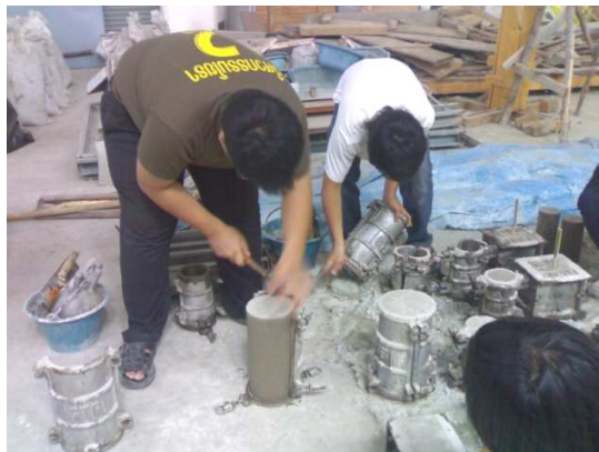
รูปที่ 3.39 การถอดตัวอย่างทดสอบออกจากแบบหล่อ
