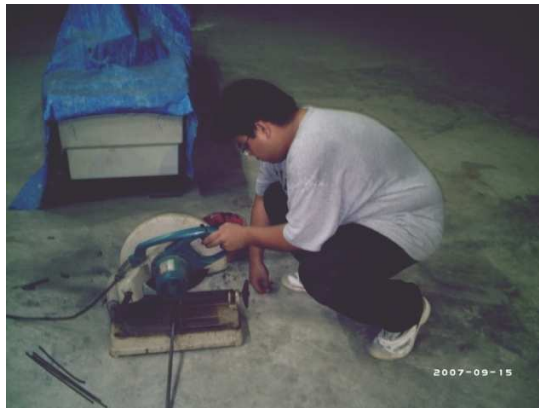
รูปที่ 3.25 การตัดเหล็กเสริมเพื่อใช้ทำแกนตัวอย่างทดสอบ
