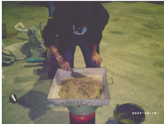
รูป 3.30 การหาค่า Absorption ของทรายที่ใช้ในการผสม
