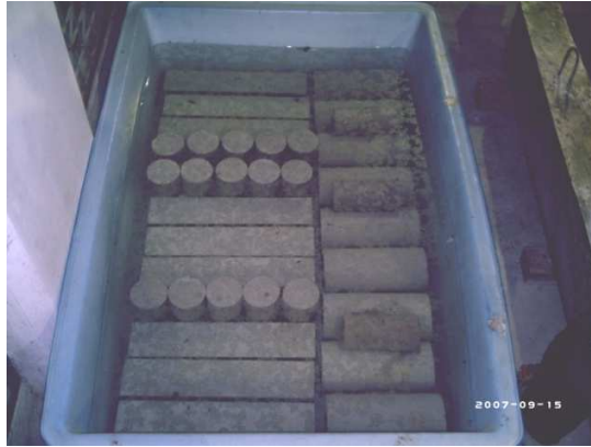
รูปที่ 3.41 การบ่มตัวอย่างทดสอบแบบจั่งน้ำ
