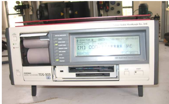
รูปที่ 3.12 เครื่องบันทึกข้อมูล “Portable data logger รุ่น TDS-303”
