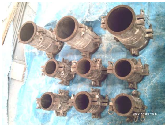
รูปที่ 3.33 แบบทดสอบกำลังรับแรงอัดของคอนกรีตที่ใช้ในการทดลอง
