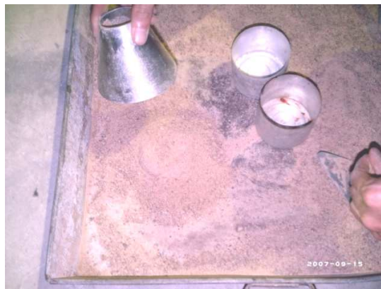
รูปที่ 3.31 การทดสอบ Cone Sand Test เพื่อหาค่า Absorption ของทรายที่ใช้ในการทดลอง
