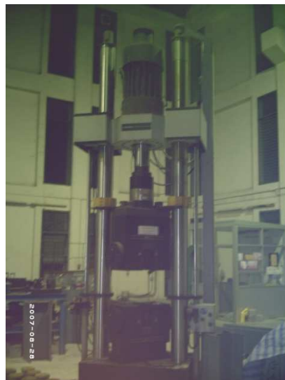
รูปที่ 3.7 ลักษณะของเครื่องทดสอบแรงดึงขนาด 150 ตัน
