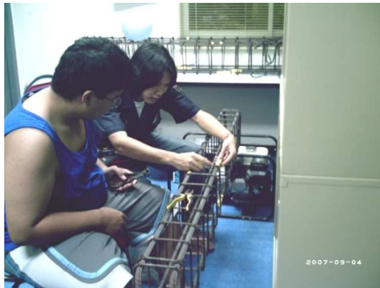
รูปที่ 3.27 การประกอบคานตัวอย่างทดสอบ
