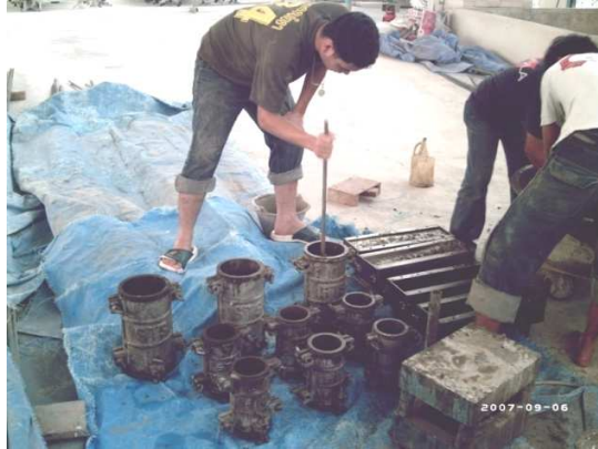
รูปที่ 3.38 การเก็บตัวอย่างคอนกรีตเพื่อใช้ในการทดสอบกำลังรับแรงที่ใช้ในการทดลอง
