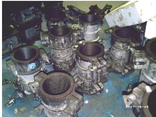
รูปที่ 3.4 แบบหล่อทรงกระบอก ขนาดเส้นผ่าศูนย์กลาง 10 เซนติเมตร และสูง 20 เซนติเมตร
