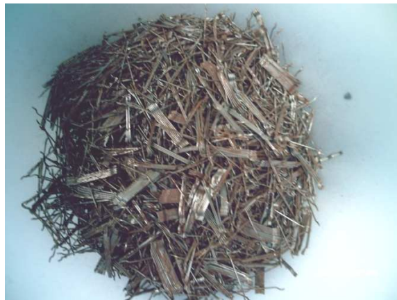
รูปที่ 3.1 ลักษณะของเส้นใยเหล็ก (Steel fiber)
