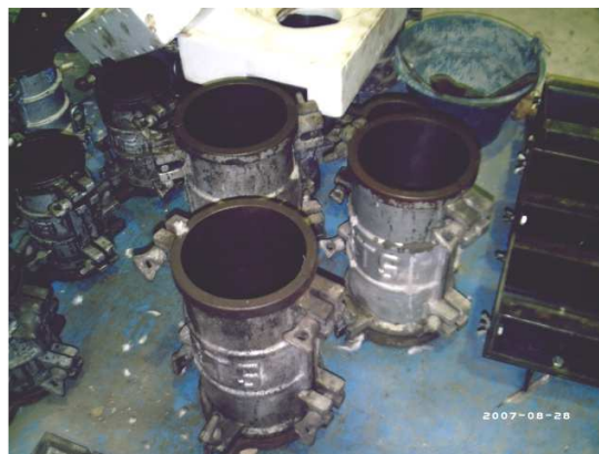
รูปที่ 3.5 แบบหล่อตัวอย่างทรงกระบอก ขนาดเส้นผ่าศูนย์กลาง 15 เซนติเมตร และสูง 30 เซนติเมตร
