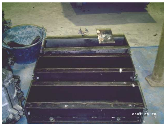
รูปที่ 3.3 แบบหล่อตัวอย่างคานขนาด 10 x 10 x 50 เซนติเมตร
