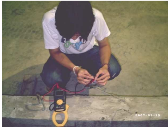
รูปที่ 3.42 การวัดความต้านทานของ Strain gauge หลังจากแกะออกจากแบบหล่อคาน
