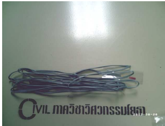
รูปที่ 3.14 อุปกรณ์วัดหน่วยการยืดหดของเหล็กเสริม
