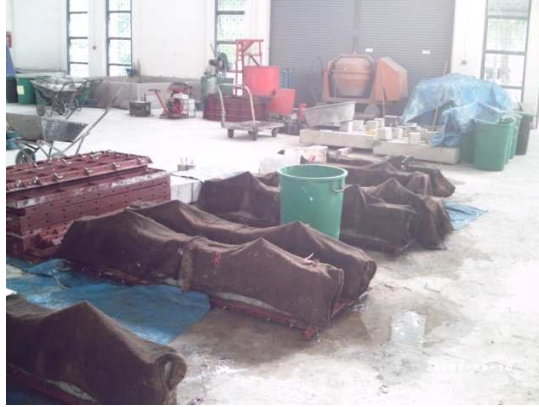
รูปที่ 3.40 การบ่มตัวอย่างกานทดสอบด้วยกระสอบ
