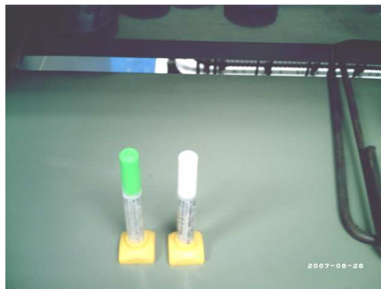
รูปที่ 3.17 กาวติดอุปกรณ์วัดหน่วยการยึดหดของเหล็กเสริม
