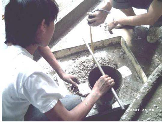
รูปที่ 3.36 การหาค่าการยุบตัวของคอนกรีตที่ใช้ในการหล่อคานตัวอย่างทดลอง
