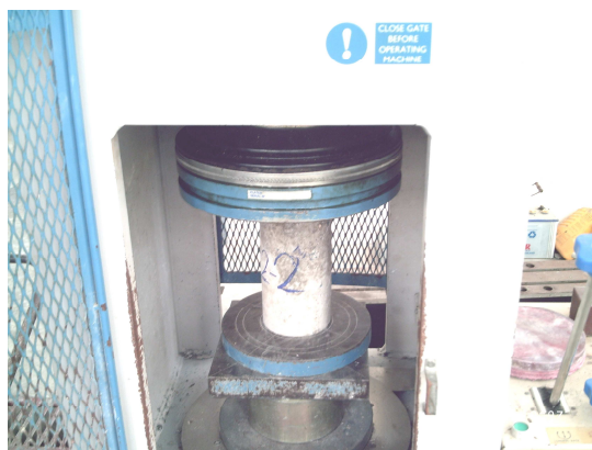
รูปที่ 3.23 การทดสอบกำลังรับแรงอัด ( f_c' ) ของตัวอย่างคอนกรีต
