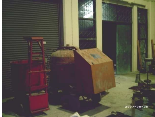
รูปที่ 3.6 เครื่องผสมคอนกรีต
