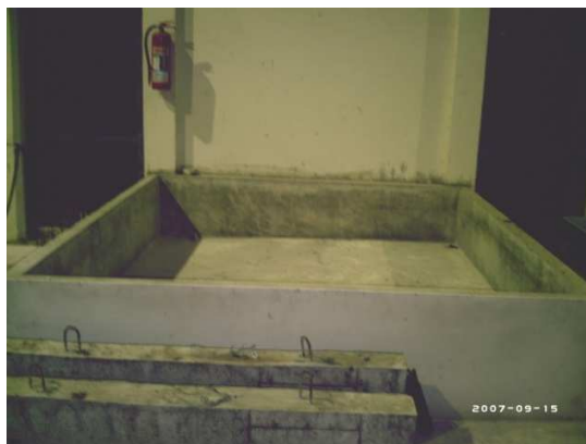
รูปที่ 3.43 บ่อสำหรับแช่คานคอนกรีตที่ใช้ในการทดลอง
