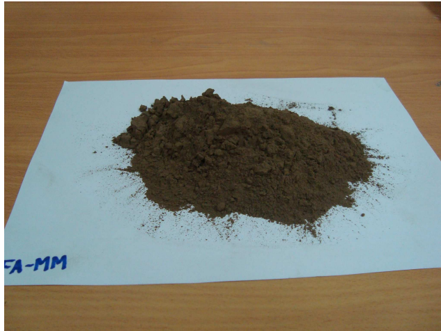
รูปที่ 3.2 เถ้าลอยแม่เมาะ (Mae Moh fly ash, FAMM)
