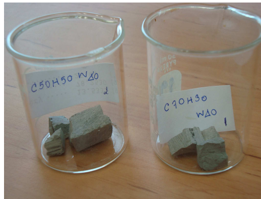
รูปที่ 3.27 ตัวอย่างซีเมนต์เพสต์ที่ตัดและผ่านการอบแล้ว
