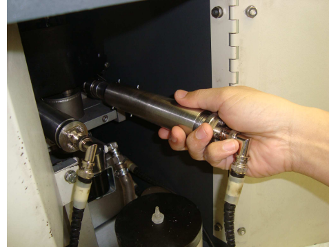
รูปที่ 3.28 การประกอบเพเนโทรมิเตอร์เข้าเครื่องอัดความดันต่ำ
