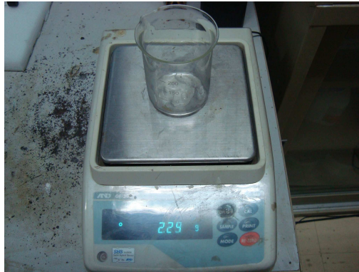
รูปที่ 3.23 การชั่งน้ำหนักสารละลายที่นำมาไตเตรท
