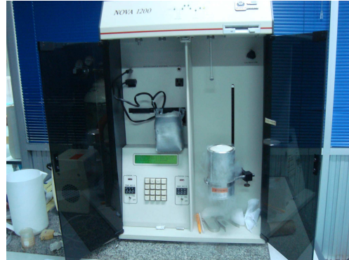
รูปที่ 3.33 การเติมไนโตรเจนเหลวและติดตั้งหลอดทดสอบ
