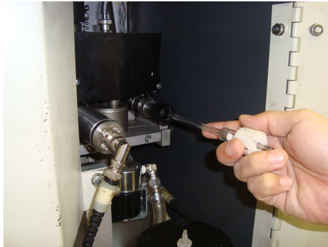
รูปที่ 3.28 การประกอบเพเนโทรมิเตอร์เข้าเครื่องอัดความดันต่ำ
