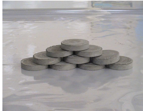
รูปที่ 3.20 ซีนตัวอย่างที่ใช้ในการทดสอบความสามารถเก็บกักคลอไรด์
