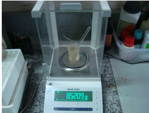
รูปที่ 3.31 การชั่งน้ำหนักหลอดทดสอบและตัวอย่างซีเมนต์เพสต์
