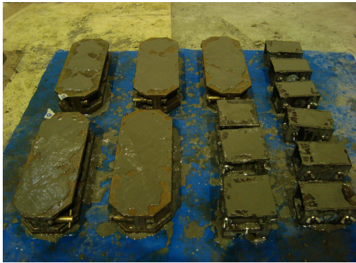
รูปที่ 3.25 ตัวอย่างซีเมนต์เพสต์ทรงลูกบาศก์
