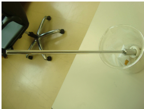
รูปที่ 3.29 เพเนโทรมิเตอร์ที่ผ่านการอัดปรอทแล้ว
