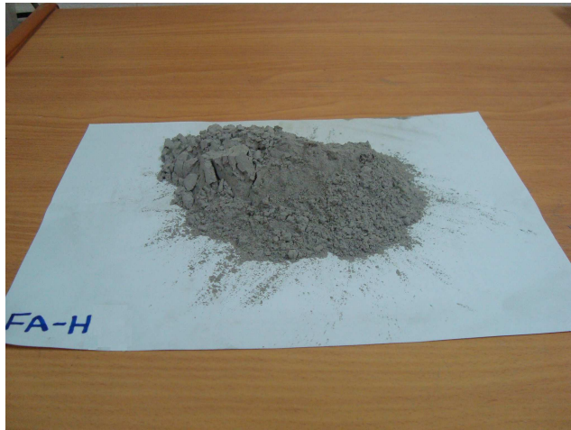
รูปที่ 3.3 เถ้าลอยระยอง BLCP-Hunter (BLCP Hunter fly ash, FAH)
