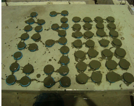
รูปที่ 3.20 ซีนตัวอย่างที่ใช้ในการทดสอบความสามารถเก็บกักคลอไรด์
