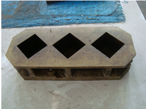
รูปที่ 3.13 แบบหล่อตัวอย่างขนาด 50x50x50 มิลลิเมตร
