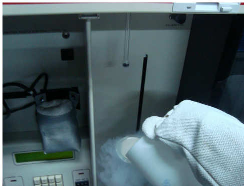
รูปที่ 3.33 การเติมไนโตรเจนเหลวและติดตั้งหลอดทดสอบ
