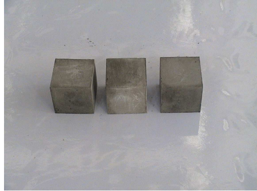
รูปที่ 3.25 ตัวอย่างซีเมนต์เพสต์ทรงลูกบาศก์
