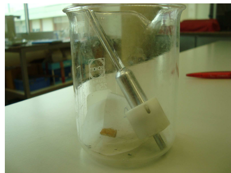
รูปที่ 3.29 เพเนโทรมิเตอร์ที่ผ่านการอัดปรอทแล้ว
