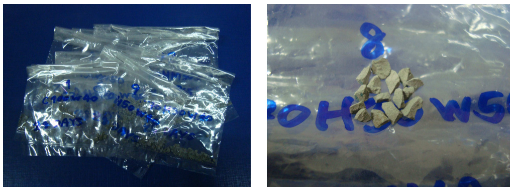
รูปที่ 3.30 ตัวอย่างซีเมนต์เพสต์ที่ผ่านการบดและอบแล้ว
