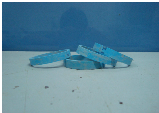
รูปที่ 3.7 แบบหล่อขึ้นตัวอย่างทดสอบความสามารถเก็บกักคลอไรด์
