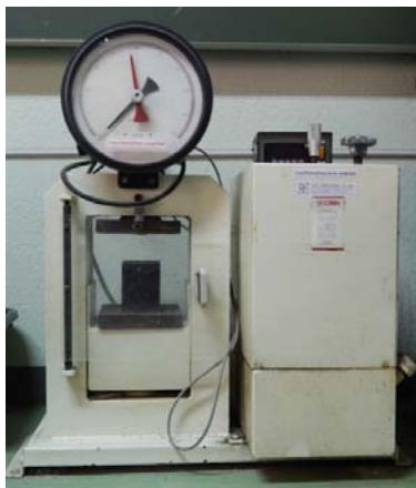
รูปที่ 2.2 เครื่องทดสอบกำลังอัดจีโอโพลิเมอร์
