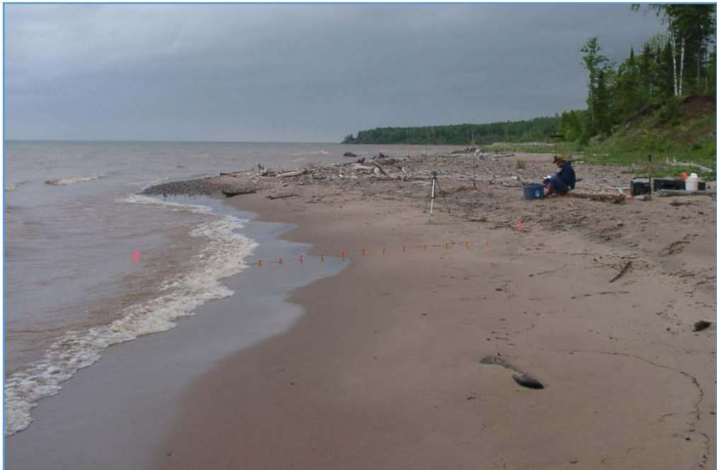
รูปที่ 2.6 การวัดความสูงคลื่นซัดในภาคสนาม (Swenson, n.d.)
