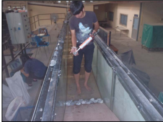
รูปที่ 3.10 การติดก้อนหินด้วยกาวซีลิโคนลงบนแผ่นไม้อัด
