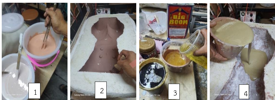
ภาพที่ 11 การหล่อแบบร่างกายด้วยยางซิลิโคน
