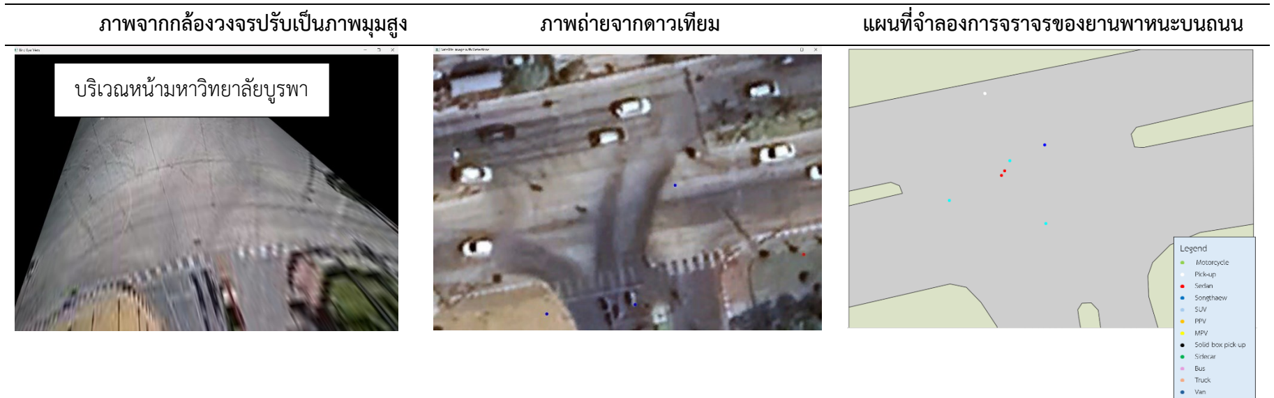
ตารางที่ 4-3 แสดงผลการแปลงภาพจากกล้องวงจรปิดเป็นภาพมุมสูงอ้างอิงตามภาพถ่ายจากดาวเทียมและแผนที่จำลองการจราจรของยานพาหนะบนถนน
