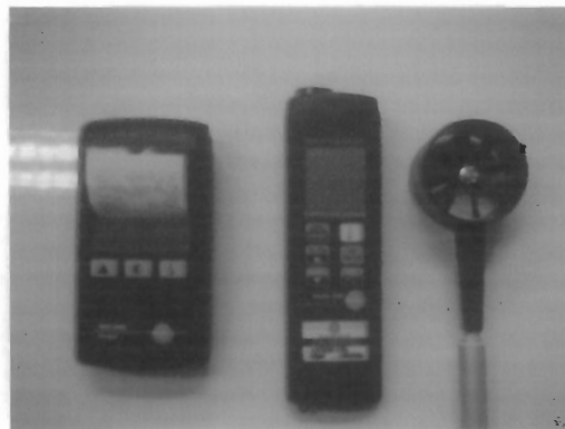
รูปที่ 3.1 แสดงเครื่องวัดอุณหภูมิและความเร็วลม
